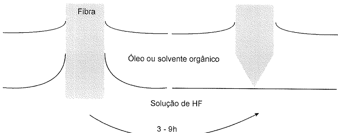
Figura 2.4.2: Diagrama ilustrando o processo de formação de ponta por menisco.
