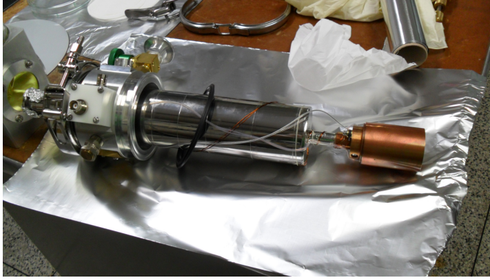
Figura 27: Criostato de N_2L aberto, com amostra e blindagem contra radiação térmica.
