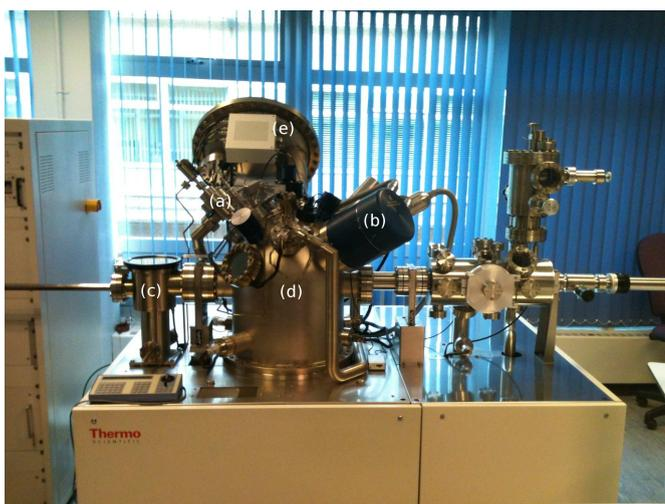
FIGURA 3.13: Equipamento ThetaProbe XPS. Fonte de raios-X (a), canhão de íons de argônio (b), câmara de inserção de amostras (c), câmara de análise (d) e analisador de fotoelétrons (e).
