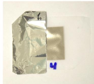
FIGURA 3.4: Fotografia da amostra PC4 e sua correspondente folha de alumínio após irradiação com íons de argônio.
