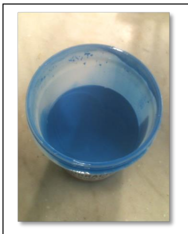
Figura 3.1 - Borracha líquida de silicone azul a ser misturada com catalisador para formar as bases que receberam as soluções de resina epóxi para confecções das amostras fotoelásticas.
