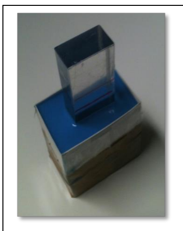
Figura 3.2 - Base de papel cartão especial envolvido com fita adesiva contendo o silicone líquido, durante a cura, com o modelo de acrílico inserido para formar a cavidade que recebeu a solução de resina.
