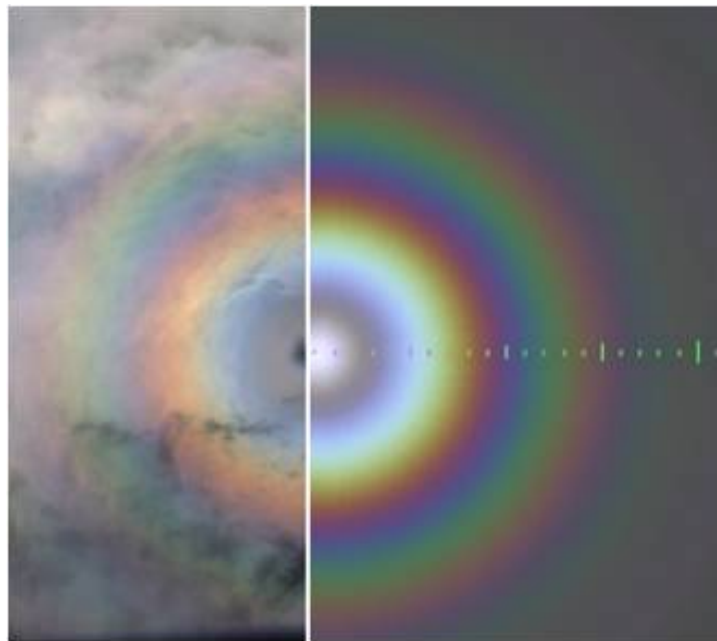
FIGURA 4.16: Comparação entre o glória simulado utilizando o programa IRIS com a configuração de distribuição uniforme de gotas com 12,50\mu\text{m} de raio, o espectro solar e o glória visualizado durante as medidas.
