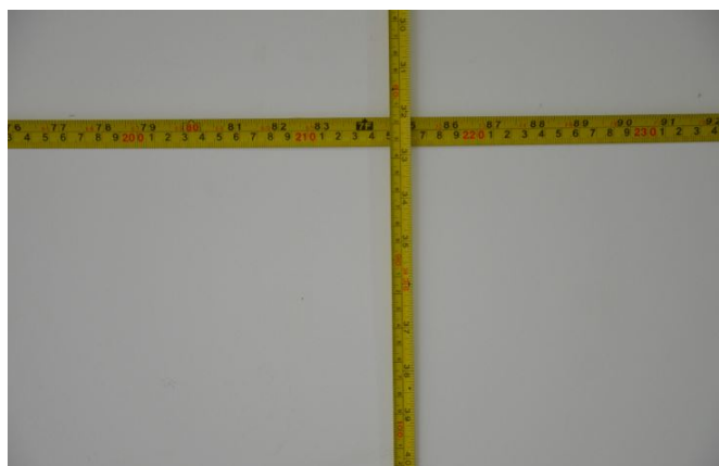
(a) Alvo utilizado para determinar-se a relação entre pixel e ângulo de abertura para a câmera visível.
