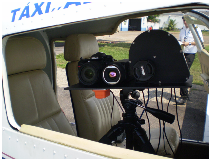
FIGURA 3.3: Disposição dos equipamentos dentro do avião sem a janela. Da esquerda para a direita: câmera RGB, infravermelho próximo e térmica. Embaixo da placa encontra-se o GPS.
