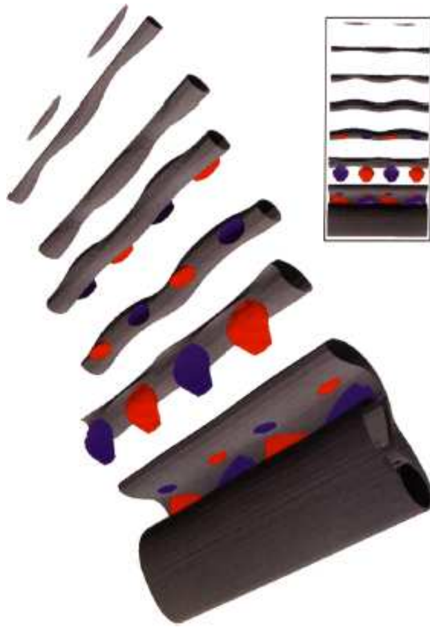
Figura 3.12: Superposição do modo crítico de Floquet na esteira de Von Kármán. Os tubos cinza são contornos de z -vorticidade |\omega_z + \tilde{\omega}_z| . Conectando os vórtices de Von Kármán, se tem regiões de x -vorticidade ( \tilde{\omega}_x ) positiva (vermelha) e negativa (azul). O modo de Floquet deforma os vórtices de Von Kármán na direção de envergadura. Extraído de Barkley e Henderson 7
