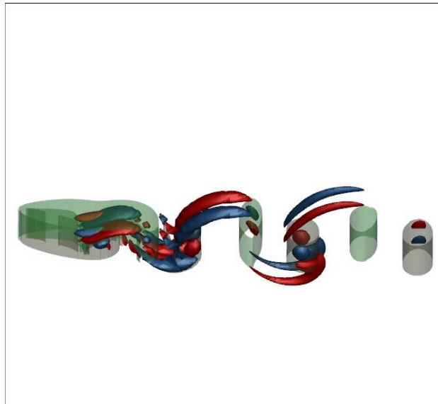
Figura 5.22: Escoamento remontado a partir do campo base bidimensional e das perturbações tridimensionais. As iso-superfícies translúcidas são de \omega_z do campo base. As iso-superfícies sólidas azuis e vermelhas representam valores negativos e positivos do modo instável \omega_x . Re = 500 , \alpha = 20^\circ , \beta = 11
