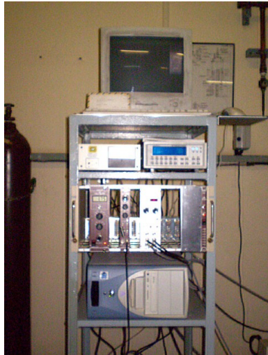
Figura 7.3: Espectrômetro Mössbauer (a), detalhe do driver Mössbauer, detector e pré-amplificador (b).
