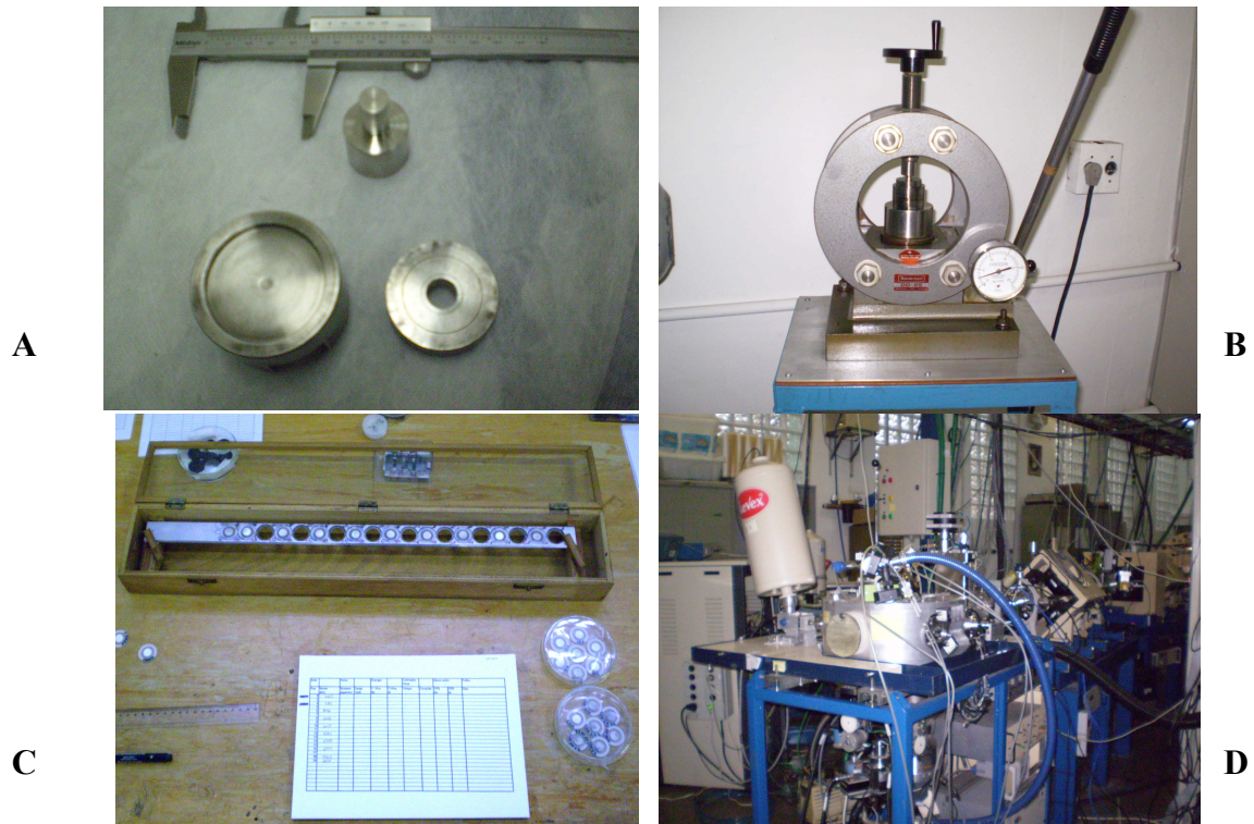
Figura 6.4: Molde para prensagem das pastilhas (A), prensa para compactação das amostras (B), pastilhas de amostra diluídas em ácido bórico fixadas no porta-amostras (C) e câmara PIXE (D).
