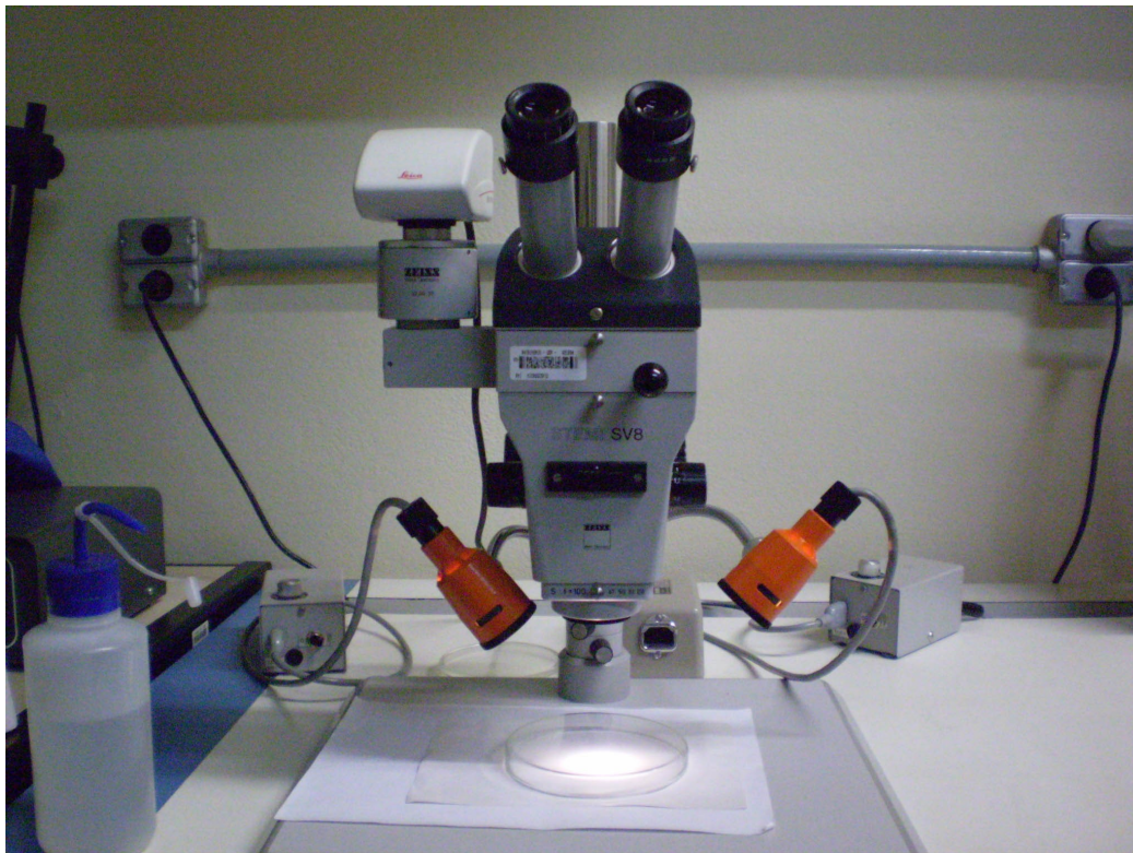
Figura 5.1: Foto do estereomicroscópio Zeiss utilizado para obter as fotos dos grãos minerais das amostras analisadas.
