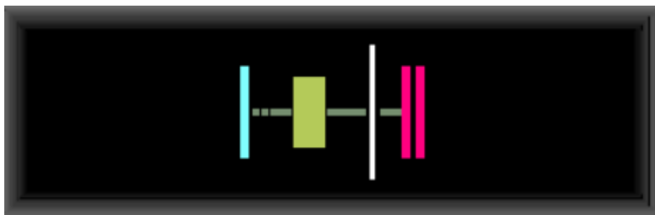
Figura 4.14 - Desenho esquemático do sistema RIBRAS simulado na plataforma LISE++. O bloco azul representa o alvo, dourado o solenoide, branco o colimador e rosa os detectores.
