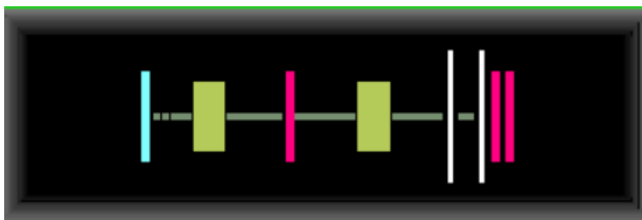
Figura 4.43 - Desenho esquemático do sistema RIBRAS simulado na plataforma LISE++. O bloco azul representa o alvo de produção, blocos dourados os solenoides, brancos os colimadores, os blocos de cor rosa são materiais, sendo o primeiro um degradador de ^{27}\text{Al} e os outros dois detectores de Silício.
