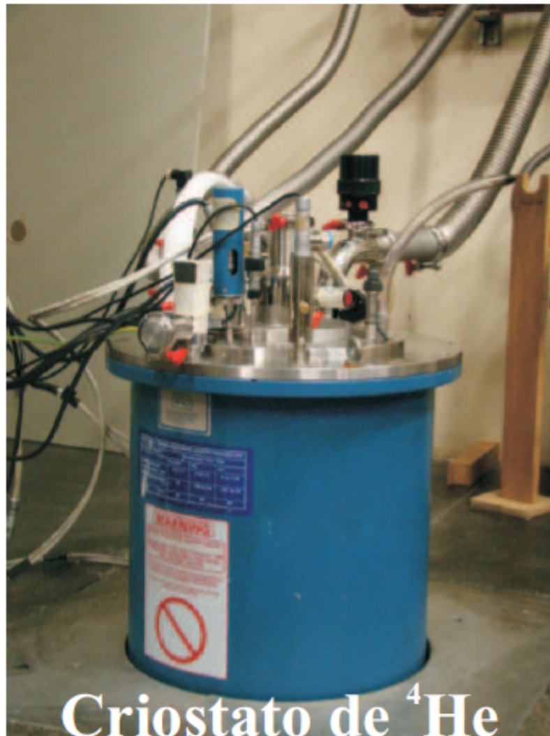
Figura 3.8: Criostato usado para realizar medidas de magnetotransporte. O criostato montado com o sistema apropriado para usar um sistema de refrigeração de {}^4\text{He} o qual funciona como um sistema VTI.
