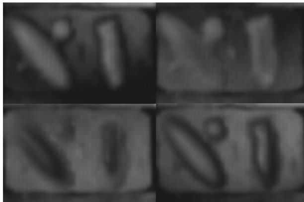
Figura 30: As quatro imagens da Figura 29, após a aplicação do filtro gaussiano, para a obtenção do padrão moiré.
