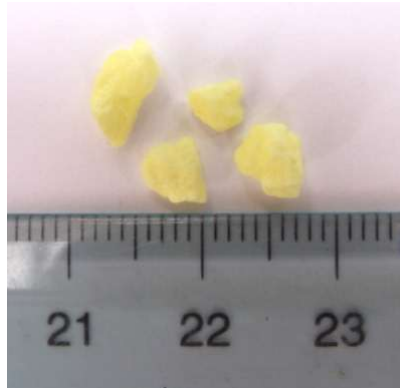
Figura 4.2: Fragmentos de enxofre como os usados nas irradiações. Régua de referência em cm.
