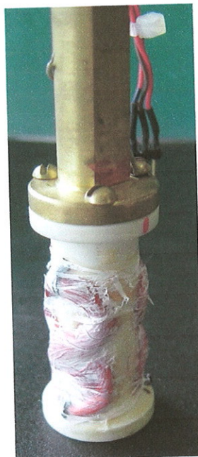
Figura 3.6 : Fotografia das bobinas sensoras fabricadas para as medidas de M vs. H das amostras.
