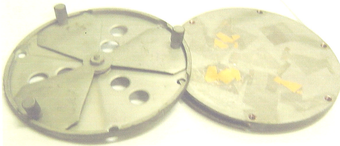
Figura 3.2 : Porta-substrato utilizado para a produção das amostras.
