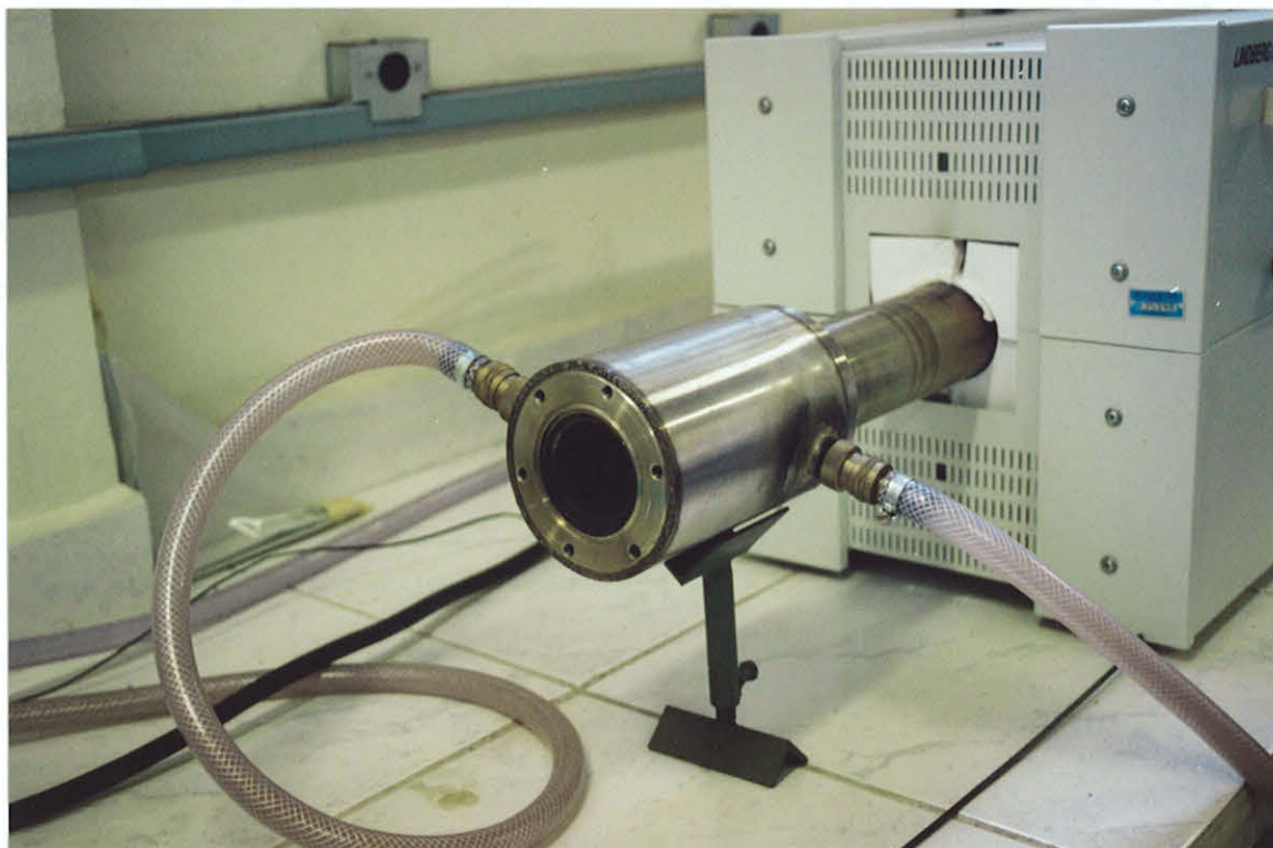
Figura 2.1.1 – Fotos do arranjo experimental montado para o tubo utilizado no forno para tratamentos térmicos sob pressão de O_2 .
