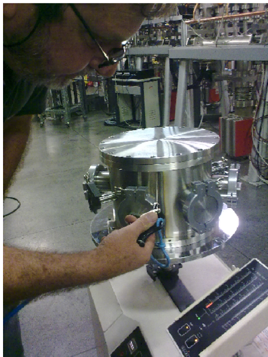
Figura 6.5: Realização do teste de vácuo. Observa-se o técnico injetando, através da ponta de prova, gás Hélio nas soldas da câmara. À direita, é visto o medidor de pressão que informa o quanto de gás vazou para dentro da câmara. O vácuo obtido com esse teste foi da ordem de 10^{-6} mBar.
