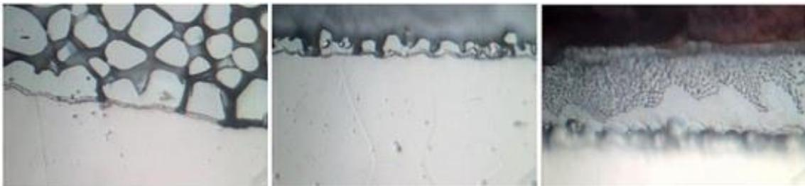
**Figura 4.19** - a) Micrografia da interface silício (acima) e nióbio (abaixo). b) Mesma micrografia de uma outra região da interface. c) Uma outra região diferente de (a) e (b) de uma camada mais fina de silício.
