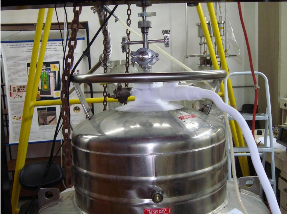
**Figura 5.45** - Formação de gelo na região da válvula V-3 (esquematizada na Fig. 5.42) de ventilação do *dewar* de LHe. Este efeito foi resultado do bombeamento de GHe do interior do *dewar* através dessa válvula. O bombeamento seria responsável por diminuir a temperatura do Hélio líquido abaixo de  $4,2\text{ K}$ .
