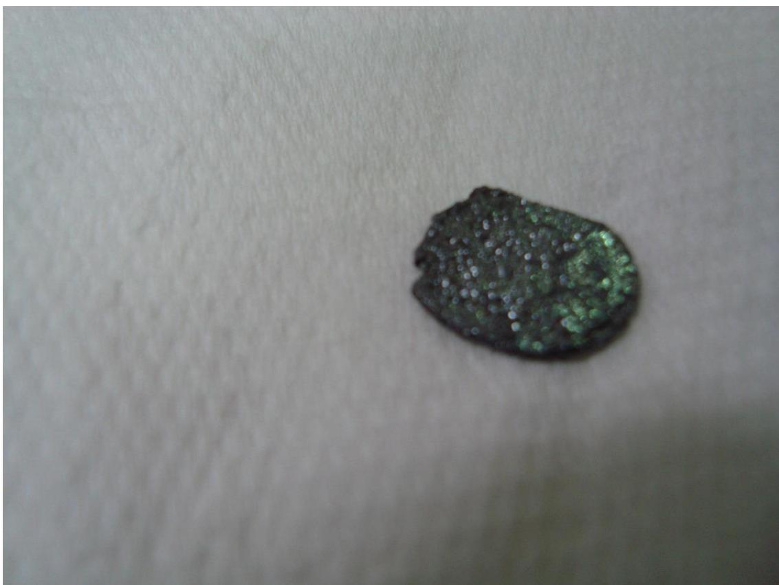
**Figura 4.16** - Ensaio LA1\_9 com corrente de  $213\text{ mA}$  aplicado durante  $60\text{ min}$ . À temperatura de  $670\text{ }^{\circ}\text{C}$ . Houve uma diminuição de massa tanto no ânodo quanto no cátodo.
