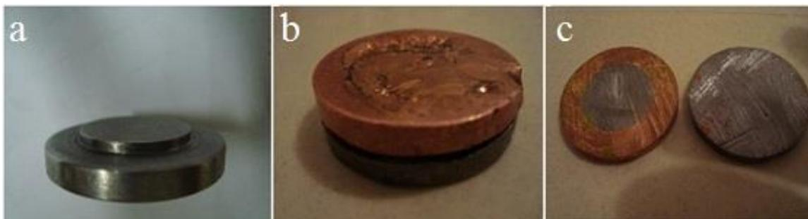
**Figura 4.21** - a) Ressalto de nióbio usinado no torno mecânico. b) Contra-molde “fêmea” de cobre, cuja região central foi fundida sobre o ressalto de nióbio. c) A região central da peça de cobre/nióbio foi cortada ao meio para destacar o ressalto.
