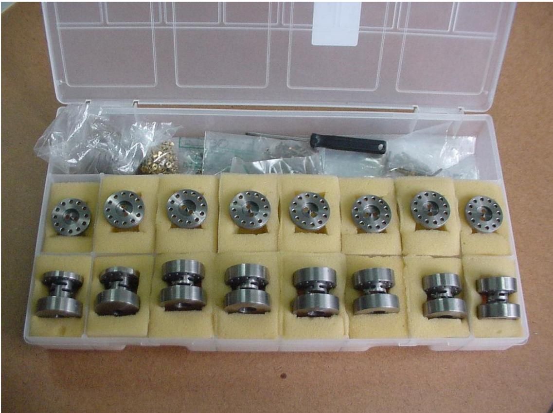
**Figura 6.3** - Transdutores de nióbio com suas respectivas cavidades reentrantes. Da esquerda para a direita, os dois primeiros deverão monitorar os modos monopolares e os outros seis deverão monitorar os modos quadrupolares da antena esférica.
