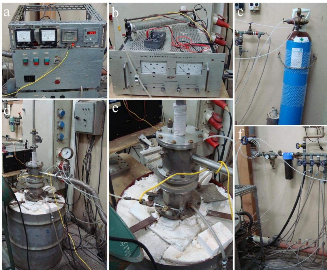
**Figura 4.11** - Montagem experimental para a realização das experiências de eletrodeposição de nióbio. a) Dispositivo controlador de temperatura. b) Fonte de tensão com potenciômetro e amperímetro. c) Garrafa para armazenamento de argônio. d) Forno de tijolo refratário. e) Câmara de espera para evitar entrada de ar na célula. f) Válvulas para o sistema de refrigeração de água e abastecimento de argônio.
