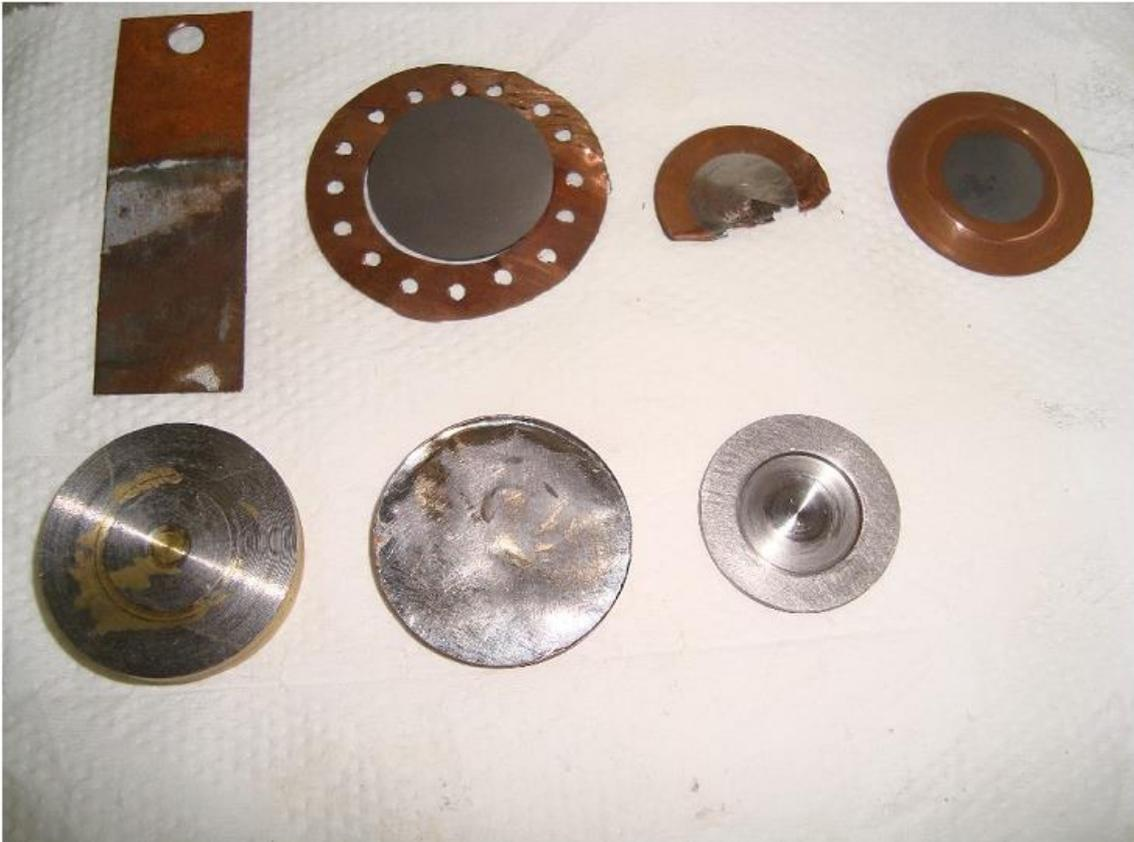
**Figura 4.3** - Exposição das tentativas de fabricação das membranas de nióbio através de diversos processos. No canto esquerdo superior foi feita uma tentativa de eletrodeposição de nióbio sobre uma placa retangular de cobre. O restante das amostras foram produzidas por fundição e afinamento mecânico.
