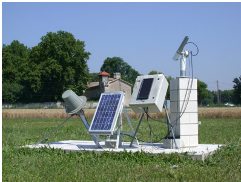
Figura 4.3.: Instrumentação da rede AERONET ilustrando o radiômetro solar CIMEL 318A, a antena de transmissão de dados e o painel solar.
