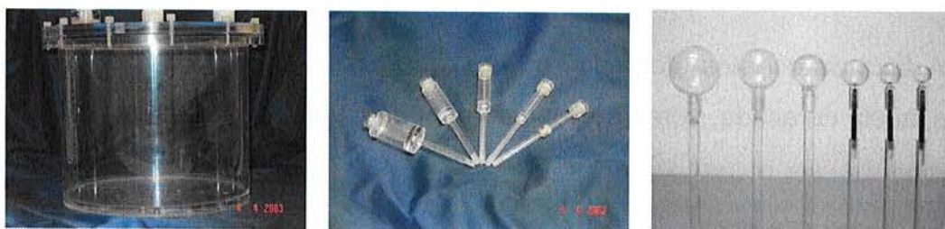
Figura 6.11: Cilindro uniforme, objetos cilíndricos e esféricos usados com a Vertex. Os objetos cilíndricos têm altura fixa de 3,7 cm.
