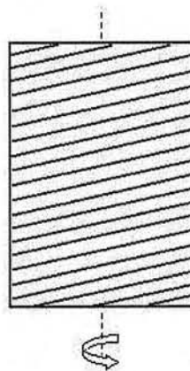
Figura 6.4.: Scatter shield usado na Vertex Plus MCD/AC (Philips/ADAC). As especificações são confidenciais do fabricante.
