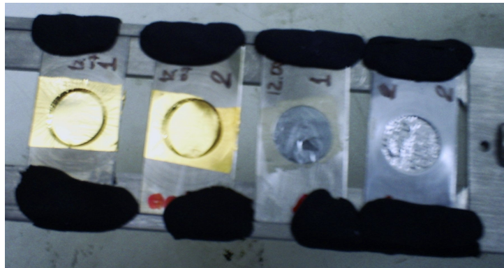
Figura 3.9: Fotos dos filmes finos de Au e Ti produzidos para as medidas de perda de energia. Os suportes dos alvos possuem a dimensão de 15 x 30 mm.
