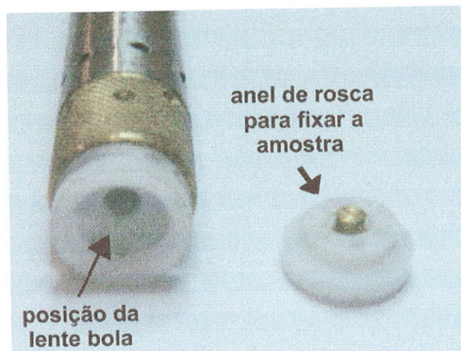
Figura 3.22: Foto da parte inferior do porta-amostra óptico. Detalhe da posição da lente bola.
