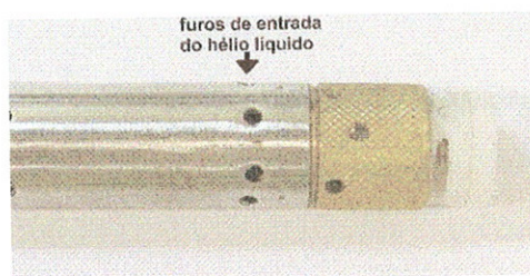
Figura 3.23: Foto da parte inferior do porta-amostra óptico. Detalhe dos furos para a entrada de hélio líquido.
