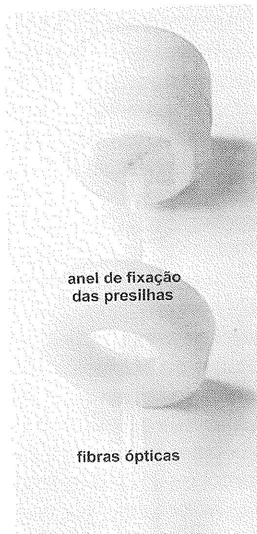
Figura 3.21: Foto do encaixe das fibras ópticas nas peças da parte inferior porta-amostra óptico.
