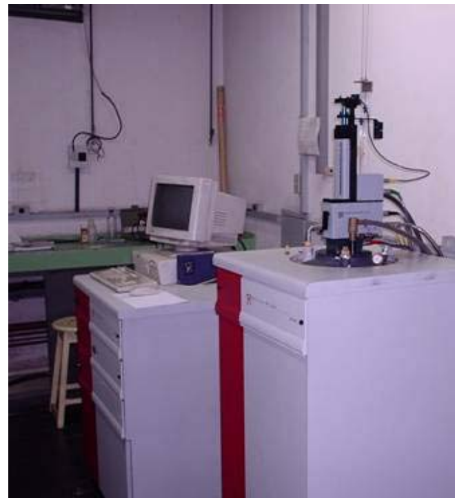
Figura 3.5: magnetômetro tipo SQUID. Ima http://macbeth.if.usp.br/~rjardim/
