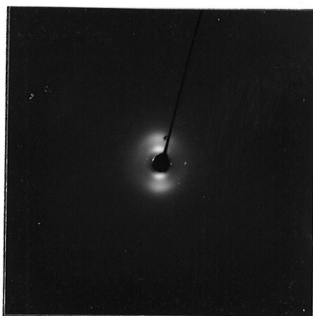
Figura 12.b: fase Nc com H presente no plano da figura, na direção horizontal (geometria G_{\perp} ).
