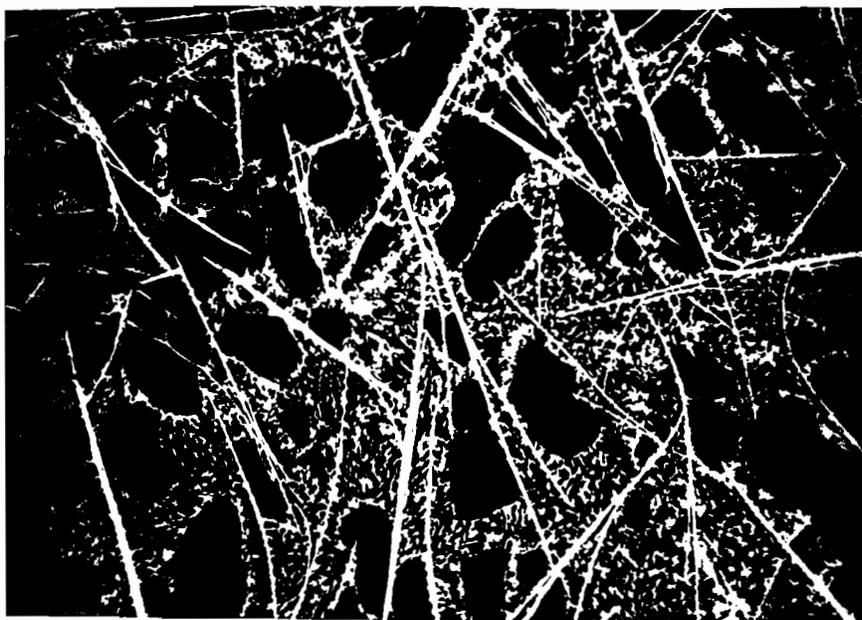
**Figura III.18** - Micrografia da amostra  $\text{Nd}_{80}\text{Fe}_{15}\text{B}_5$ , no estado bruto de fusão (aumento de 1000 vezes).
