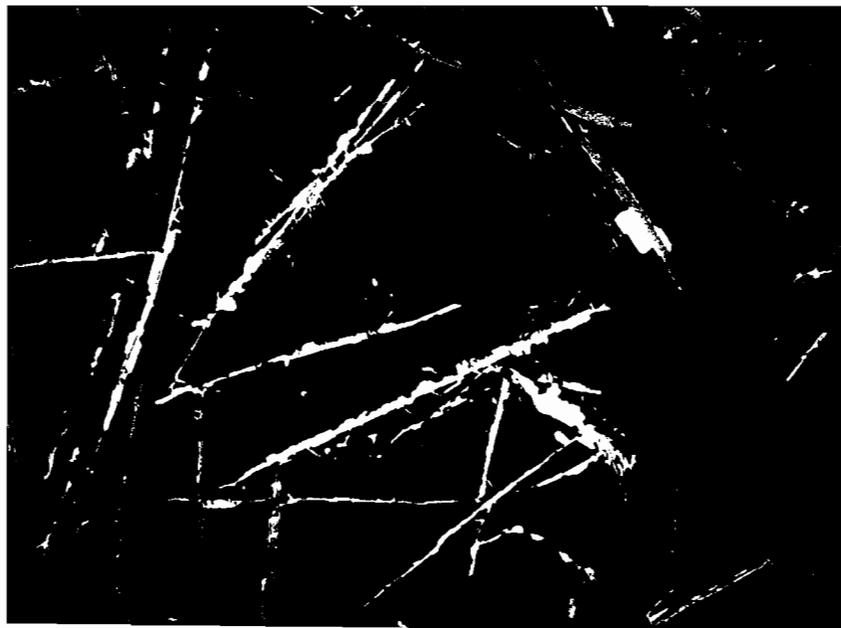
Figura III.22 - Micrografia da amostra  $\text{Nd}_{15}\text{Fe}_{80}\text{B}_5$ , tratada termicamente a  $600^\circ\text{C}$  durante 24 horas (aumento de 1000 vezes).
