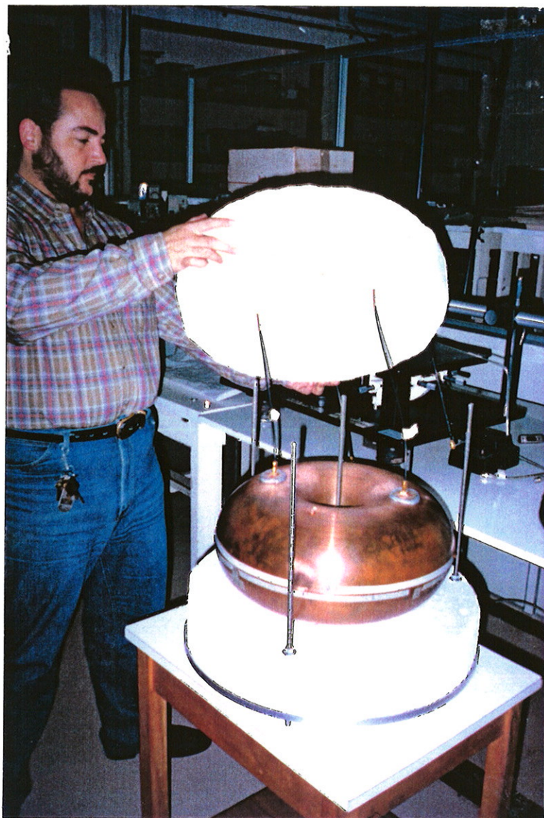
Foto 3.2 : Etapa de Montagem da Cavidade Toroidal e do seu Suporte .
