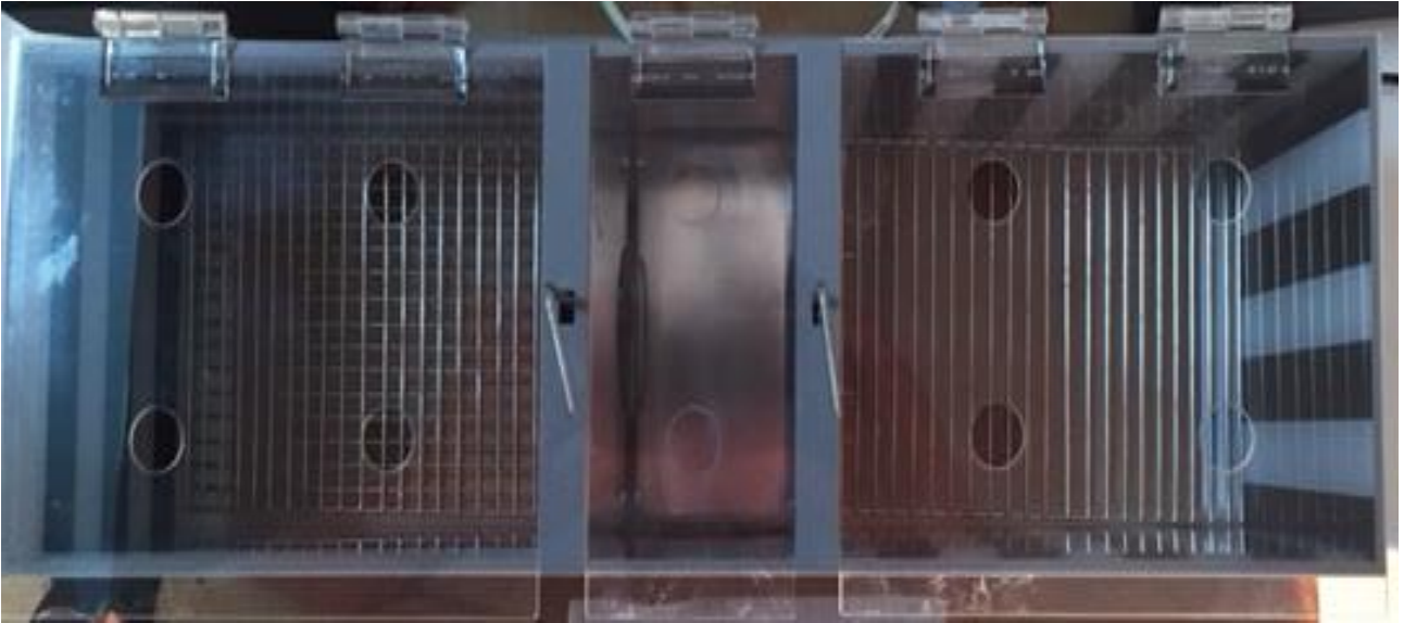
Figura 6- Aparato manual de preferência condicionada por lugar da empresa Insight ™ EP 156C visão superior.
