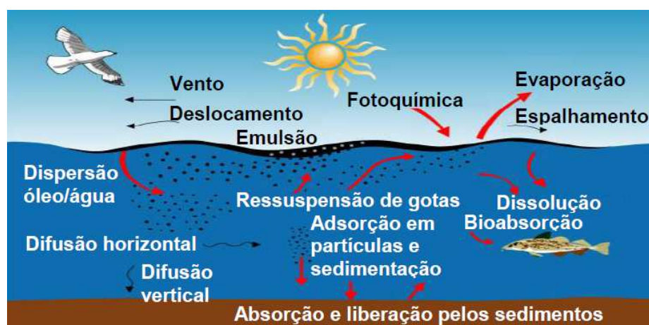
Figura 5. Ilustração dos fenômenos envolvidos no processo de intemperismo de uma mancha de óleo espalhada sobre a água do mar (Fonte. Vieira, 2009).
