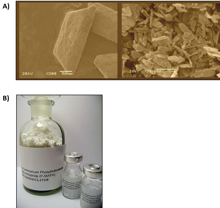
A) Cristais fotografados por microscópio eletrônico de varredura. À esquerda, em aumento de 300x, e à direita, em aumento de 25000x. (Fotos: FARMABRAILIS, 2008). B) Cristais de P-MAPA em embalagens fornecidas pela Farmabrazilis. (Foto: FARMABRAILIS, 2010).
