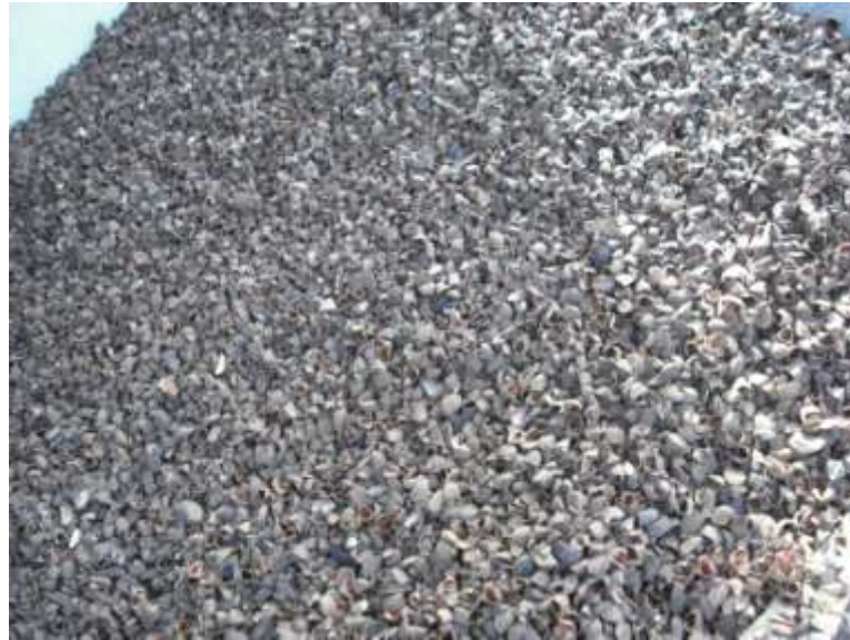
Figura 38- Cascas de castanhas utilizadas como combustível do forno
