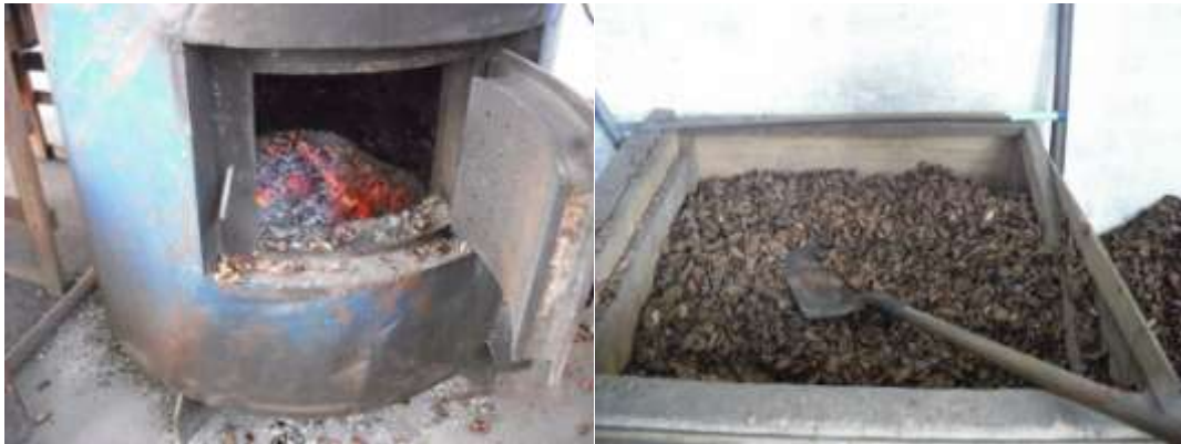
Figura 24 – Forno de autoclave abastecido com resíduos de cascas de castanhas
