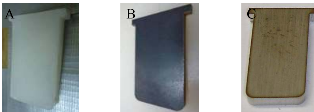
Figura 25 – Corpos de prova utilizados nos ensaios de corrosão. A) aço carbono SAC350, B) aço inoxidável martensítico F6NM - X3CrNiMo13-4; e C) Polipropileno.
