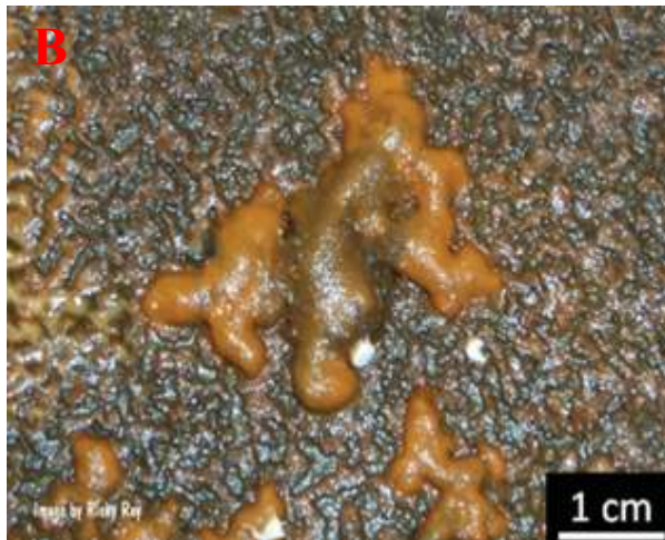
Figura 14 – Tubérculo de corrosão induzidos microbiologicamente por bactérias do gênero Gallionella . A) Esquema apresentando as diferentes espécies químicas relacionadas com o processo corrosivo durante a formação de uma massa tubercular; B) Detalhe de um tubérculo de corrosão; C) micrografia de bactérias do gênero Gallionella isoladas do interior de um tubérculo de corrosão.
