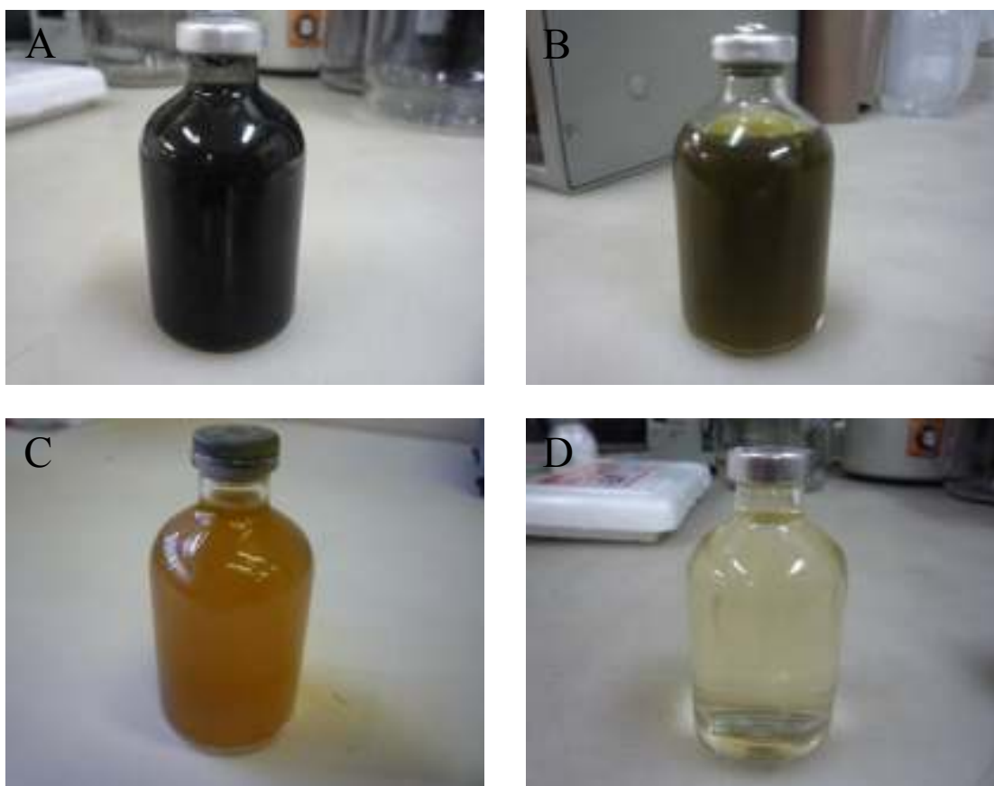
Figura 24 – Meio de cultivo para isolamento de grupos bacterianos a partir do biofouling formado sobre os equipamentos da UHE de Pedra do Cavalo. A) bactérias redutoras de sulfato (APHA, 1999); B) bactérias redutoras de ferro (GOULD et al., 2003); C) bactérias oxidantes de ferro (ZAKHAROVA; PARFENOVA, 2007); D) bactérias oxidantes de manganês (ZAKHAROVA; PARFENOVA, 2007).
