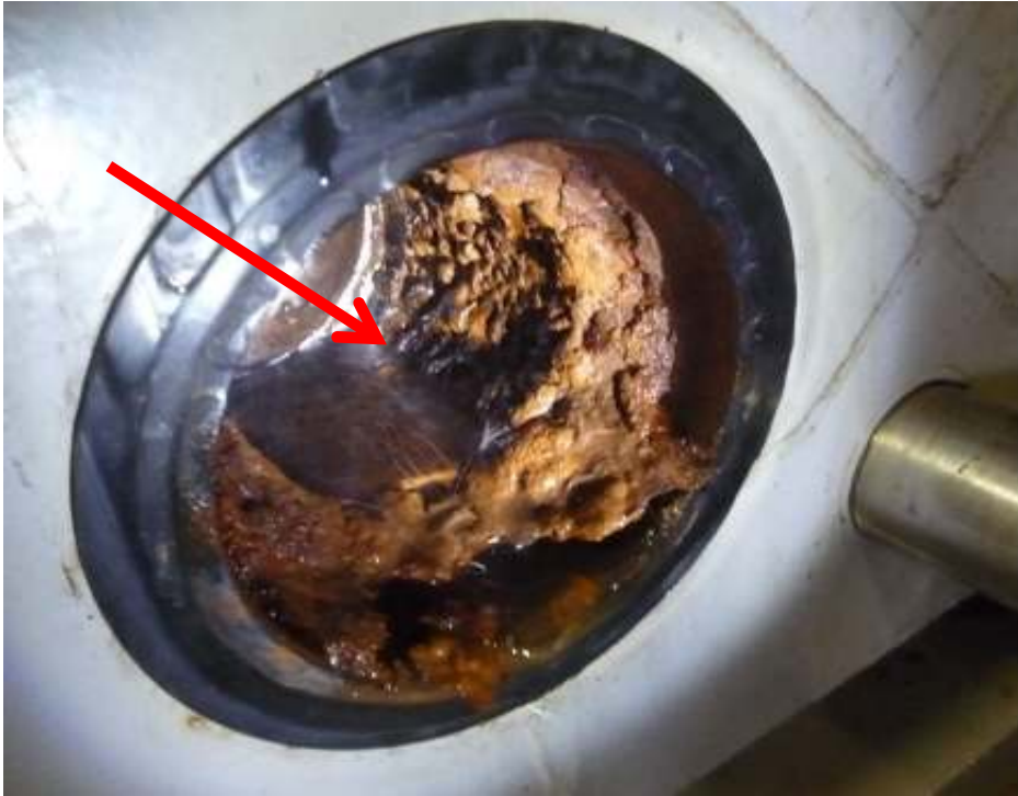
Figura 11 – Biocorrosão em tubulação da entrada de um radiador da UHE de Pedra do Cavalo, BA. Detalhe da formação de tubérculos de corrosão.
