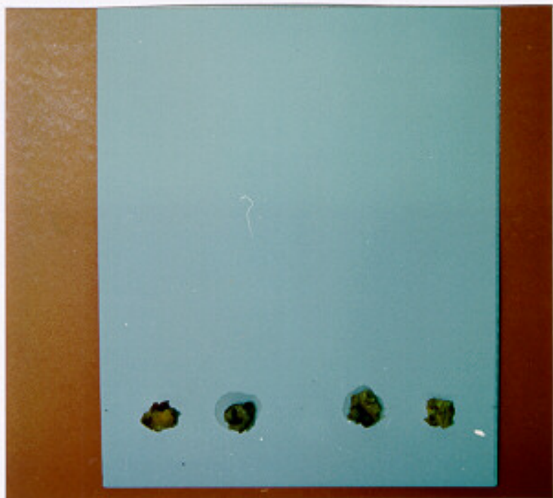
Figura 20 – Placa cromatográfica contendo “plugs” de meio de aveia com o fungo.
