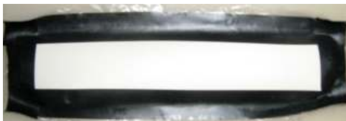
Figura 13: Superfície da membrana exposta ao crescimento de biofilmes (área de 33,6 cm 2 ).
