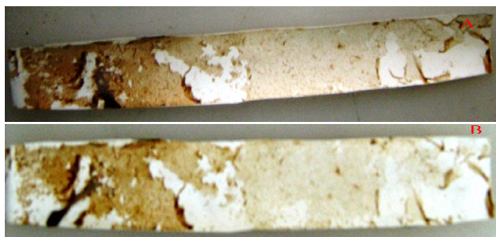
Figura 41: Uma das amostras de membrana antes da sonicação (A) e depois da sonicação por 5 minutos (B).
