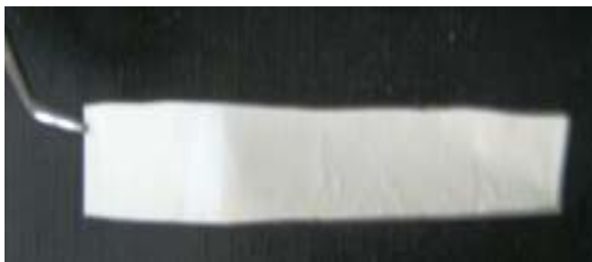
Figura 36: Região do permeado de uma das amostras de membrana após três meses submersas em um tanque contendo água da raia da USP. Não foi observado crescimento de biofilmes nesta região, mostrando que o isolamento desta área funcionou corretamente.
