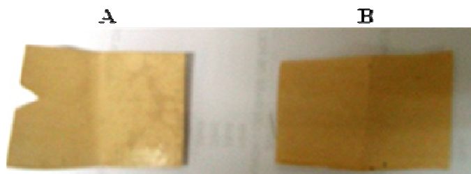
Figura 31: Amostra de membrana após a sonicação (A) e amostra de membrana colmatada (B). Visualmente, o método de sonicação retirou apenas uma camada superficial do material depositado sobre a amostra. Essas amostras não são as mesmas do experimento, porém, são do mesmo elemento de membrana.
