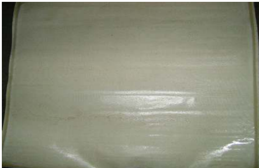
Figura 14: Imagem de um envelope de membrana de osmose reversa indicando uma camada de fouling homogênea. Nos dois elementos analisados, visualmente, a camada de fouling possuía as mesmas características.
