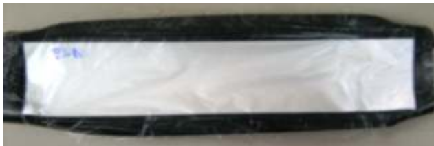
Figura 12: Isolamento da região do permeado de uma das amostras de membranas de osmose reversa utilizadas no crescimento de biofilmes. A região do permeado foi isolada utilizando saco plástico, envolvendo toda a região, e fita isolante para fixar este plástico.
