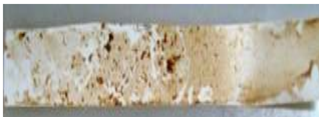
Figura 37: Isolamento da região de uma das amostras de membrana onde ocorreu a formação de depósitos com área de 33,6 cm 2 .
