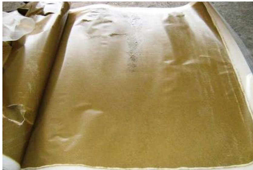
Figura 8: Abertura de um elemento de osmose reversa para a observação dos envelopes de membrana.
