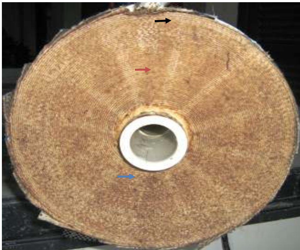
Figura 15: Região de entrada da água de alimentação de um dos elementos de membrana colmatados. As setas indicam as regiões ou envelopes de membranas que foram utilizados para a coleta das amostras. Três envelopes de cada região foram utilizados para a coleta das amostras. A seta azul indica os envelopes de membranas mais próximos à região do coletor de permeado, a seta vermelha representa os envelopes da região mediana e a seta preta indica os envelopes externos, ou seja, mais distantes do coletor de permeado.
