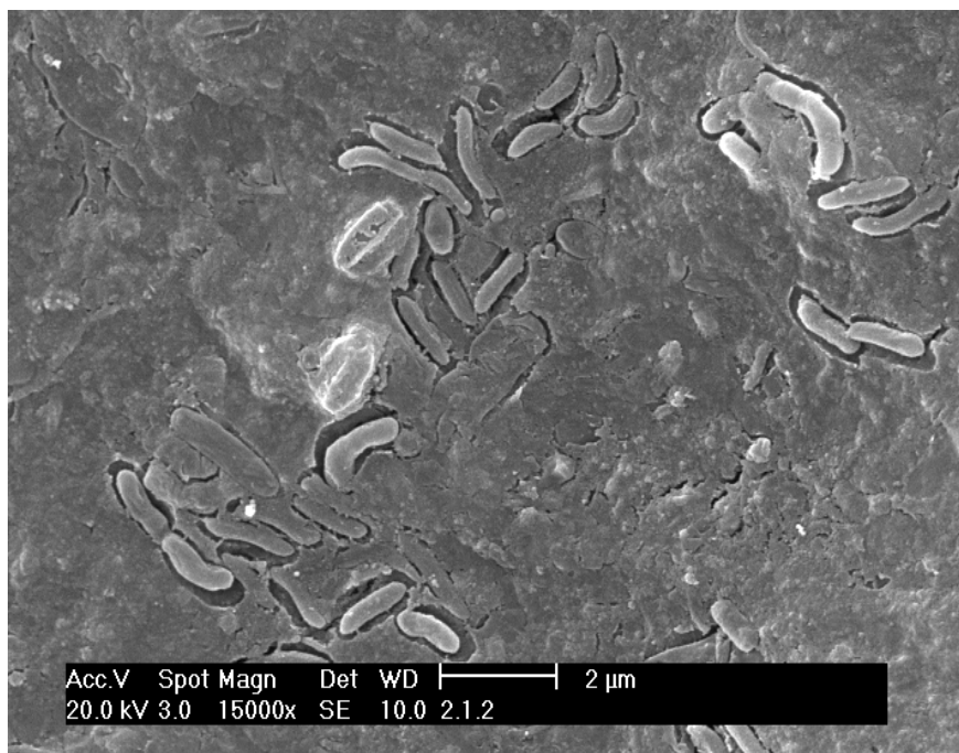
Figura 11: Micrografia de uma amostra de membrana de osmose reversa apresentando biofilmes.
