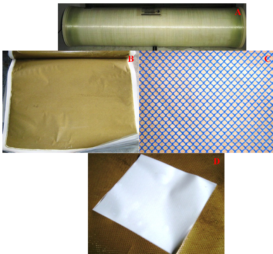
Figura 4: Elemento de osmose reversa fechado (A) e após abertura do elemento em (B); a coloração escura dos envelopes de membrana se deve ao acúmulo de depósitos em suas superfícies ( fouling ). O espaçador de alimentação (C) localiza-se entre os envelopes de membrana gerando turbulência e mistura. O espaçador de permeado (D) é uma tela muito fina que se localiza dentro de cada envelope de membrana ajudando no escoamento do permeado e evitando o colapso entre as folhas de membranas.
