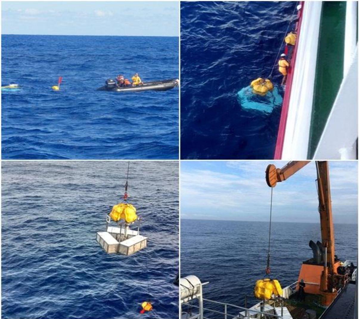
Figura 4 - Resgate dos landers contendo os substratos sintéticos e orgânicos, a bordo do NPo Almirante Maximiano (H-41) da Marinha do Brasil em Maio de 2015. Fotos de Cristina Rossi Nakayama.
