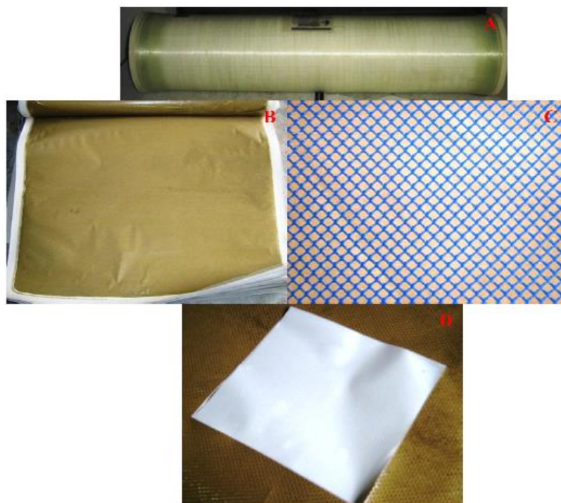
Figura 5 - Elemento de osmose reversa fechado (A) e após abertura do elemento em (B). A coloração escura dos envelopes de membrana se deve ao acúmulo de depósitos em suas superfícies (fouling). O espaçador de alimentação (C) localiza-se entre os envelopes de membrana
