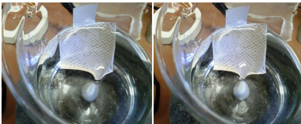
Figura 45 - Amostras de membranas de osmose reversa durante o procedimento de limpeza química de bancada.
