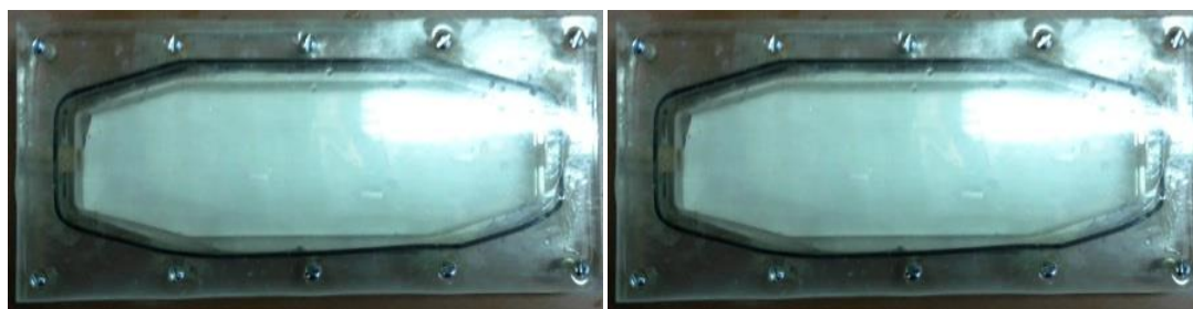
Figura 36 - Duas células de fluxo montadas com amostras de membranas limpas dentro.
