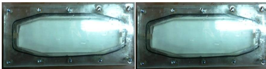
Figura 24 - Duas células de fluxo montadas com amostras de membranas limpas dentro.
