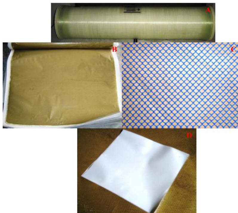
Figura 5 - Elemento de osmose reversa fechado (A) e após abertura do elemento em (B). A coloração escura dos envelopes de membrana se deve ao acúmulo de depósitos em suas superfícies (fouling). O espaçador de alimentação (C) localiza-se entre os envelopes de membrana gerando turbulência e mistura. O espaçador de permeado (D) é uma tela muito fina que se localiza dentro de cada envelope de membrana.
