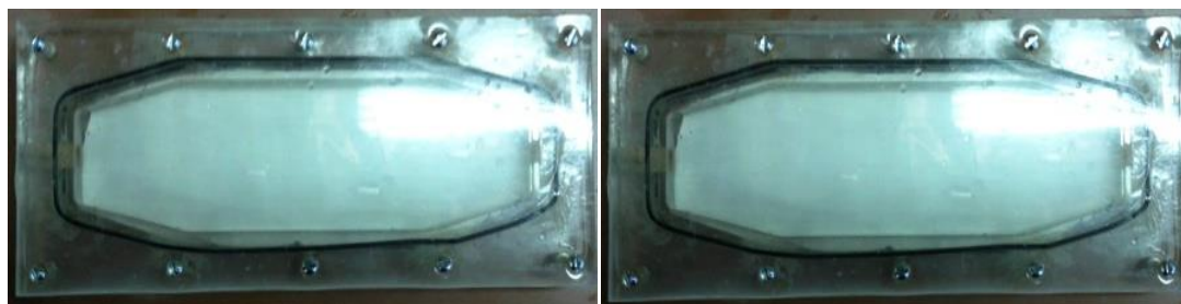
Figura 47 - Duas células de fluxo montadas com amostras de membranas limpas dentro.
