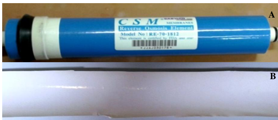
Figura 23 - Elemento de osmose reversa novo (A) utilizado para obtenção de amostras (B).
