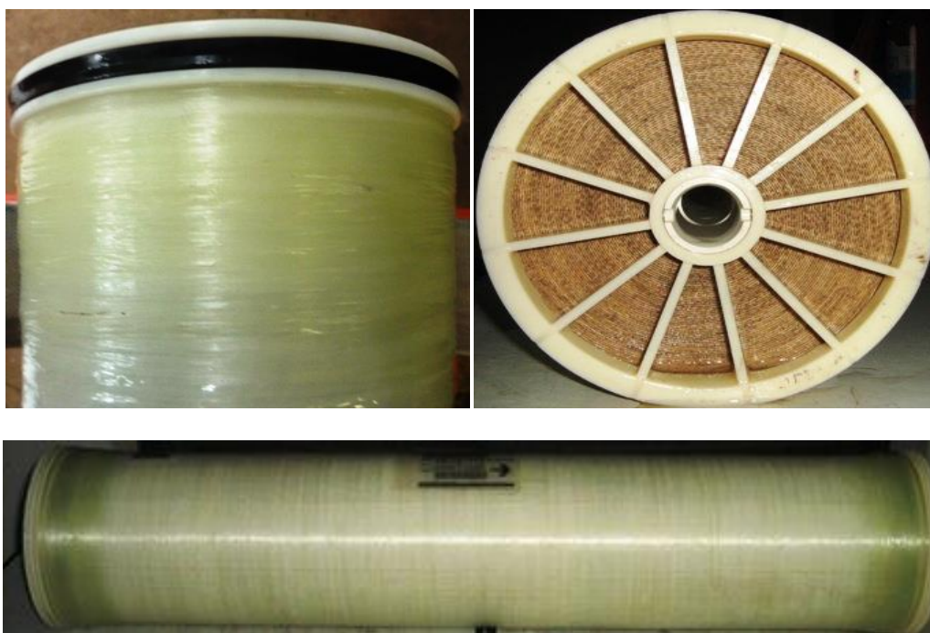
Figura 13 - Revestimento externo de fibra de vidro de um elemento de osmose reversa colmatado.
