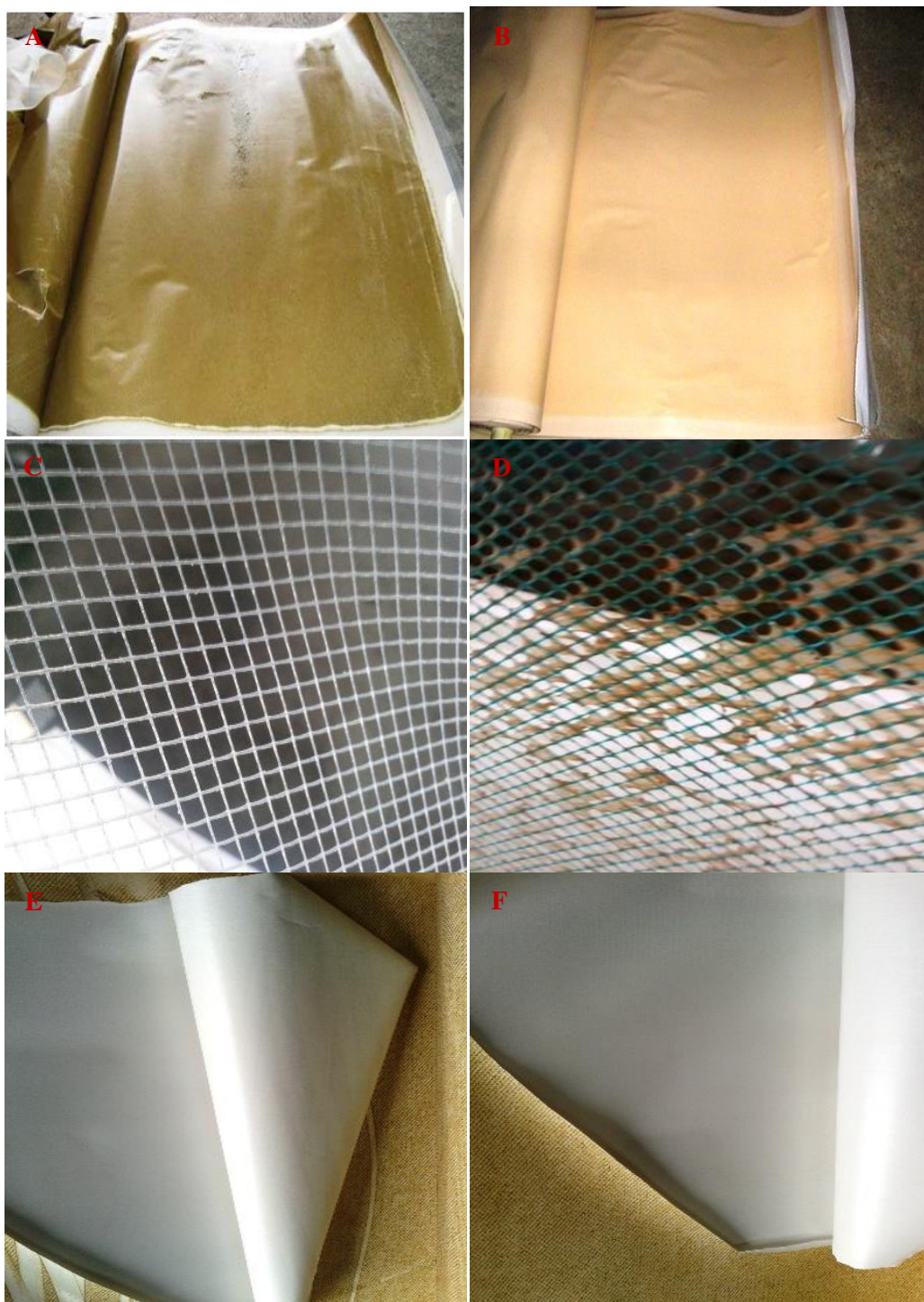
Figura 14 - Pacotes de membranas desenrolados (A e B). Espaçadores de alimentação sem depósito (C) e com depósito (D). Acesso aos espaçadores de permeado após corte da membrana (E e F).
