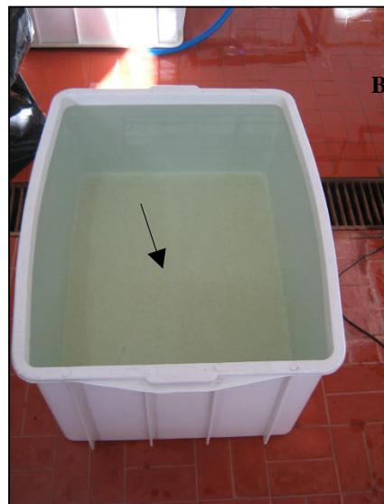
**Figura 3.** Tratamento da água do reservatório da Barragem de Ponte Nova. Em A: água antes de se tornar ideal para a utilização nos bioensaios, em B: água com solução estoque de alumínio após o período de 12 horas para decantação das partículas em suspensão. Seta aponta para material decantado.
