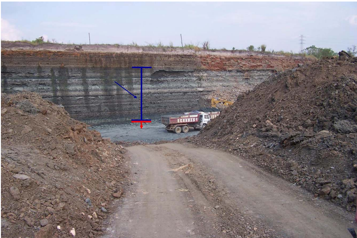
Fig.3. Frente de exploração da Extrativa Santa Fé, em 2005. É possível observar na Fm. Tremembé os diferentes níveis de folhelhos (em azul), tendo na base a camada de argila esverdeada (em vermelho). Foto: H. Alvarenga.
