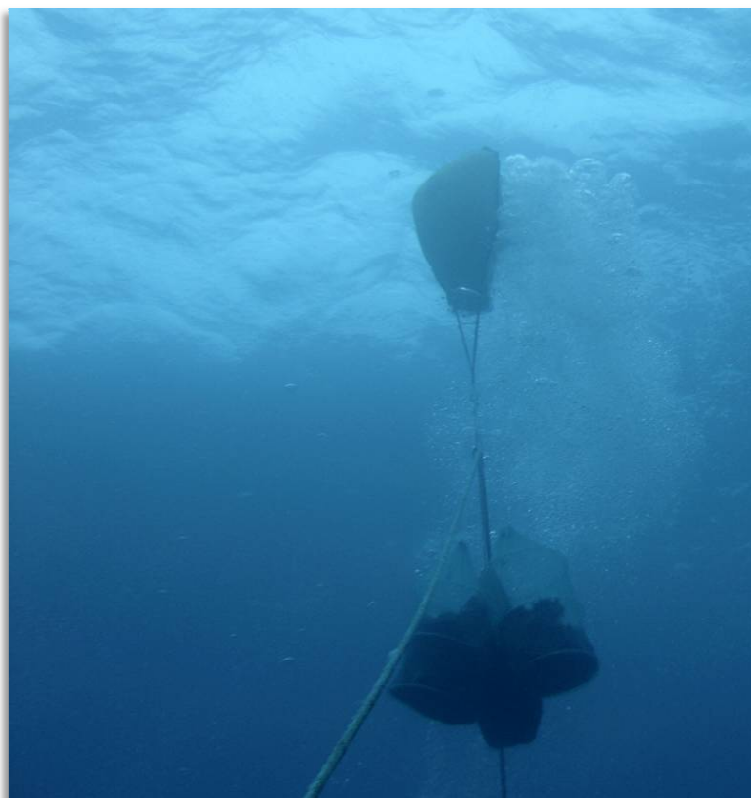
FIGURA 5: MATERIAL COLETADO SENDO TRANSPORTADO À SUPERFÍCIE ATRAVÉS DE “LIFT-BAG” (FOTO: AMADO-FILHO, G.M.).
