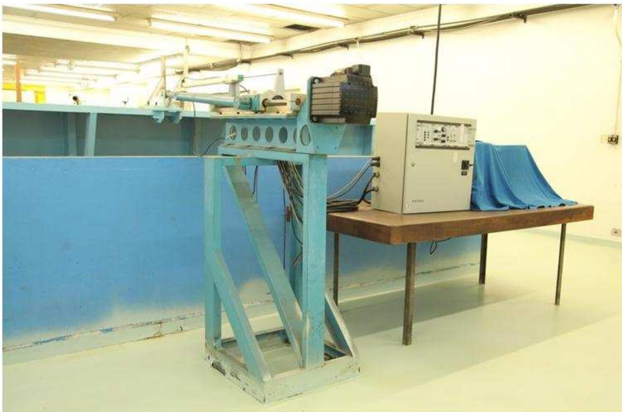
Figura 83 - Atuador e controlador do flap gerador de ondas
