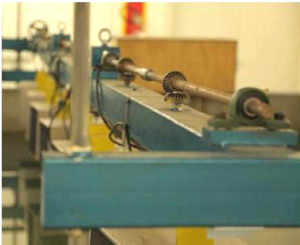
Figura 80 - Detalhe da transmissão de ângulo do sistema de geração de vento
