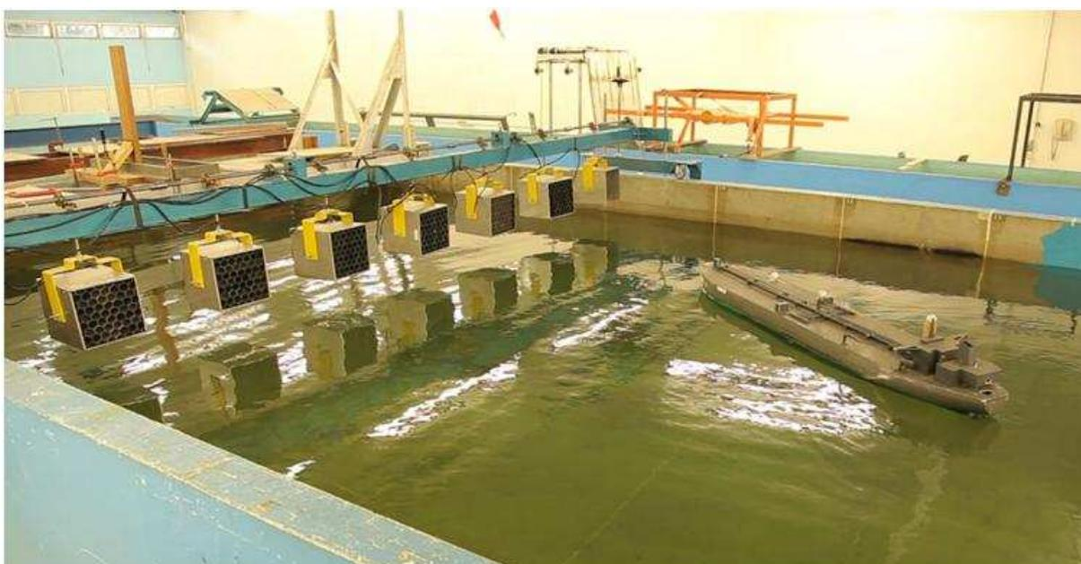
Figura 79 - Geradores de vento instalados no tanque de provas
