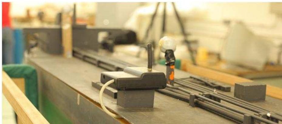
Figura 88 - Módulo RF conectado ao modelo
