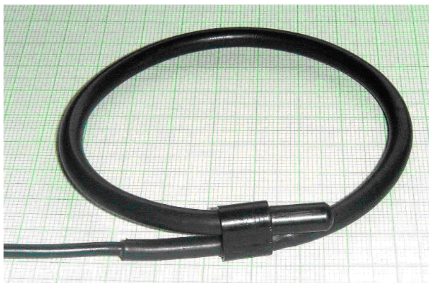
Figura 3.7 - Uma bobina Rogowski usada na medição de corrente
