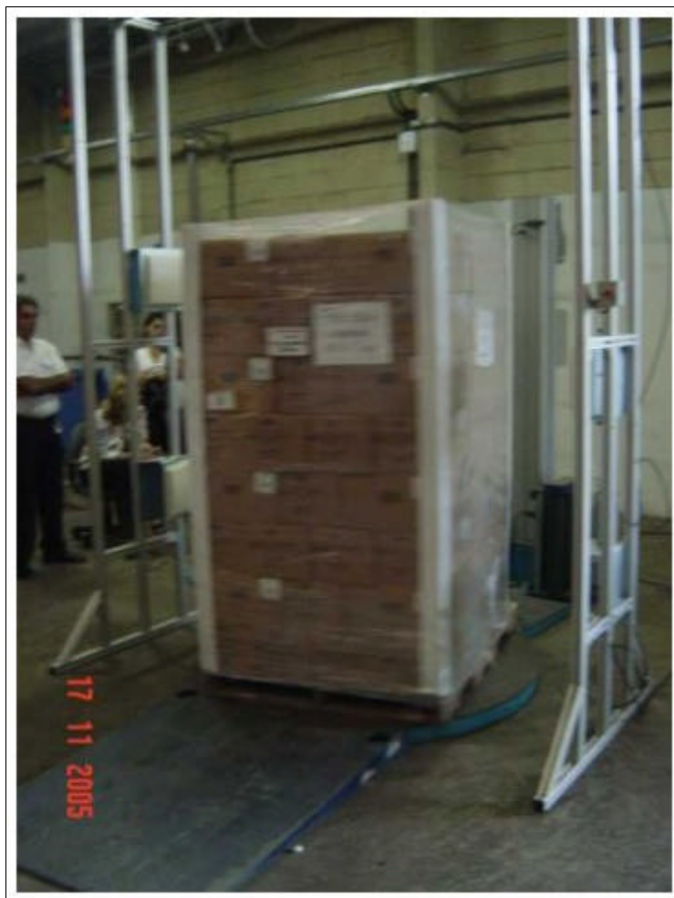
Figura 90 - Portal RFID com palete no momento da leitura
