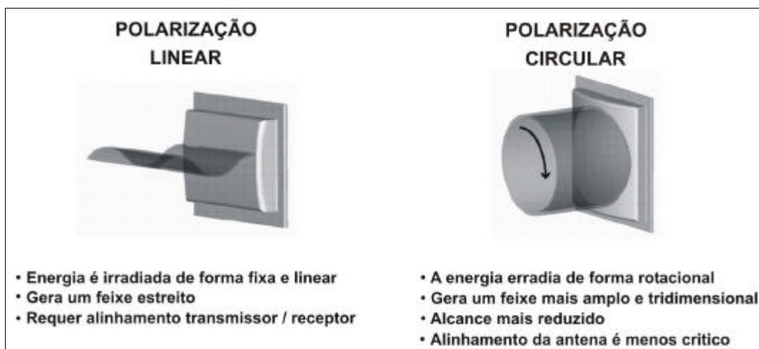
Figura 34 - Propagação das ondas na antena [ FONTE: www.seal.com.br ]
