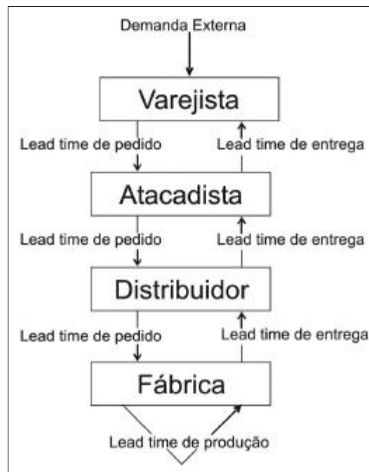
Figura 11 - Esquemático do efeito chicote ao longo da Cadeia de Suprimentos [FONTE: SIMCHI-LE et al., 2003]
