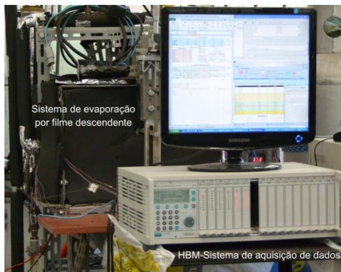
Figura 4.24. Fotografia do sistema de aquisição de dados e sistema de evaporação por filme descendente.
