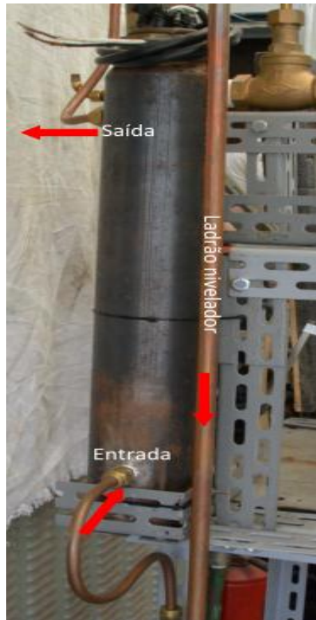
Figura 4.12 Pré-aquecedor de água para o sistema de evaporação por filme descendente.
