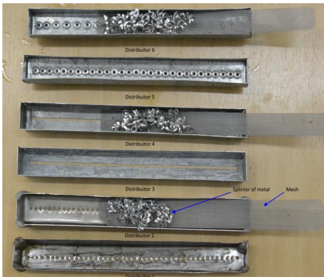
Figura 4.5 Tipos de distribuidores testados no sistema de evaporação por filme descendente.
