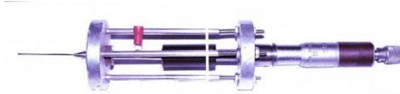
Figura 3.10 Sonda de medição de espessura com arranjo por micrômetro (Awad e Negeed, 2008).
