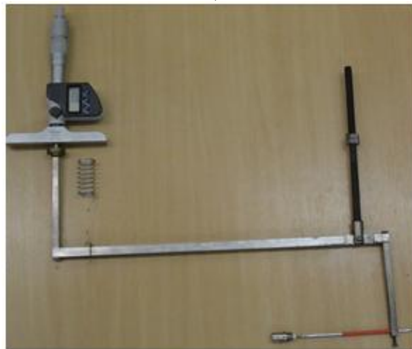
Figura 4.15 a) Esquema representativo do dispositivo de medição e, b) fotografia do sistema de medição da espessura do filme em tubos horizontais.
