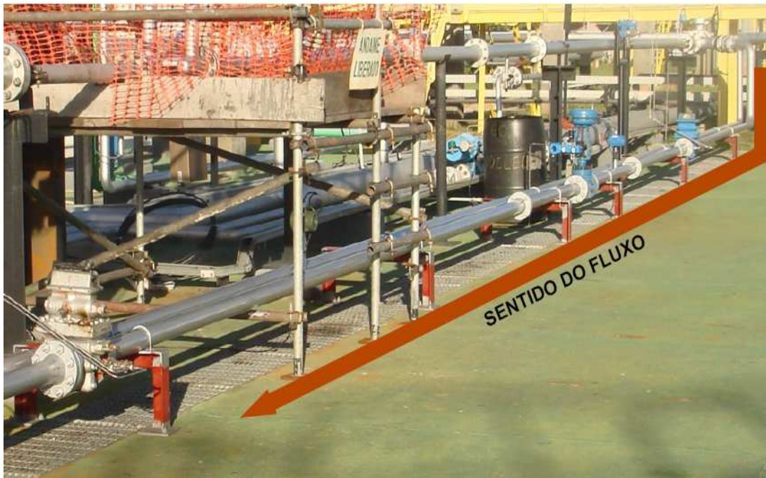
Figura 5.5: Circuito multifásico da bancada de testes.
