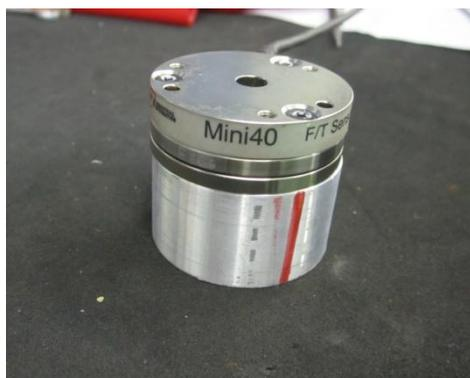
Figura 8-16: Célula de carga utilizada.
