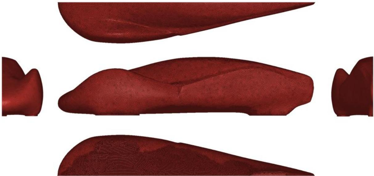
Figura 5-8: Vistas em planta da malha superficial no veículo. Na vista inferior pode-se ver a diferença das regiões com elementos de 5 e 10 mm.
