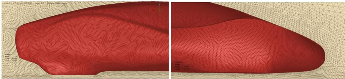
Figura 5-11: Detalhes dianteiro e traseiro da malha do veículo e da simetria.
