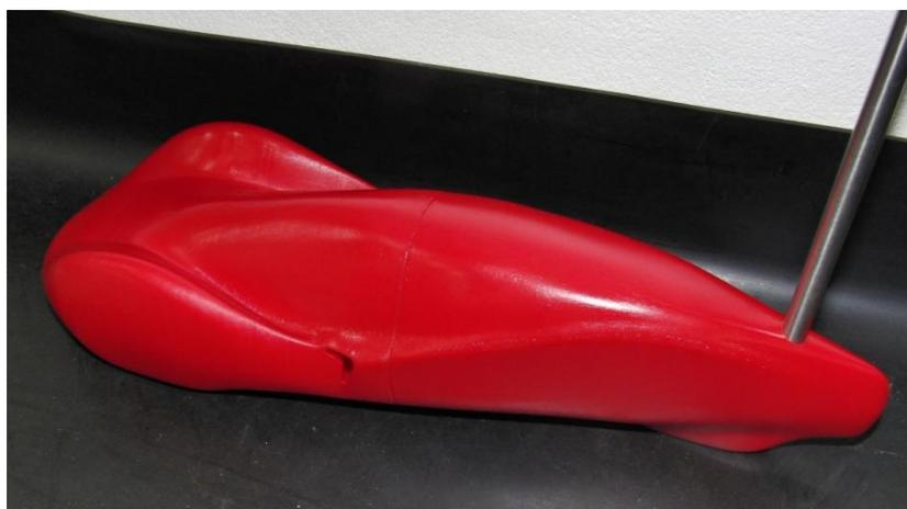
Figura 9-1: Modelo com o eixo montado.
