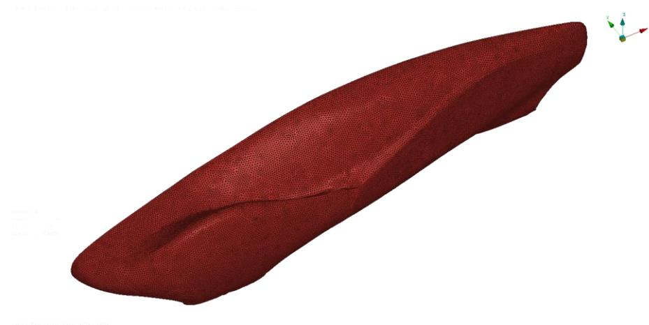
Figura 5-7: Vista isométrica da malha superficial no veículo.
