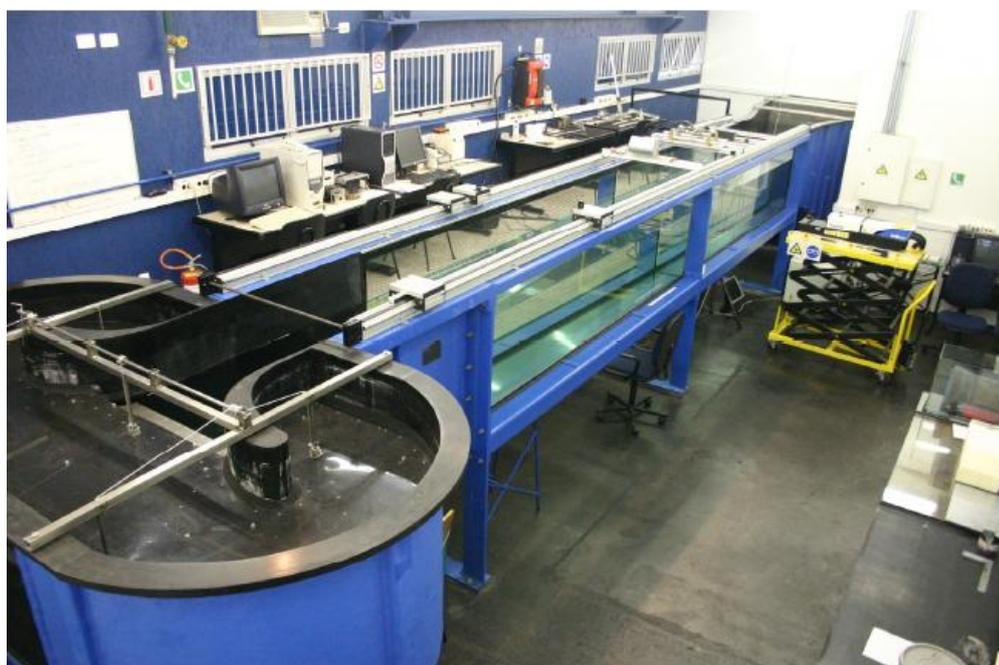
Figura 8-12: Canal de água circulante do laboratório NDF utilizado nesse trabalho (ÁSSI, 2005, p. 268).
