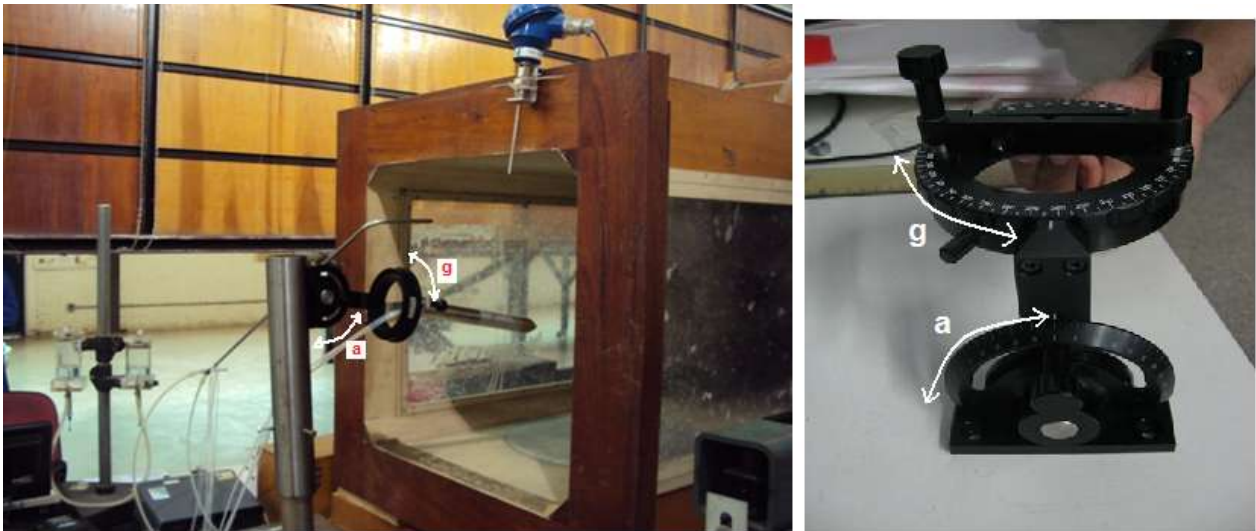
Figura 55 – Ângulos de posicionamento da sonda pirâmide no escoamento.
