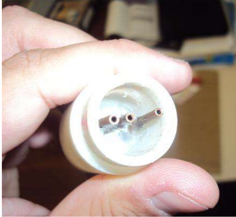
Figura 45 – Tubos de cobre colados na parte interna das pontas de sonda.
