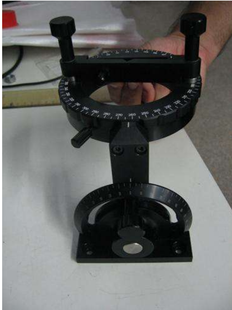
Figura 48 – Dispositivo posicionador para a sonda direcional
