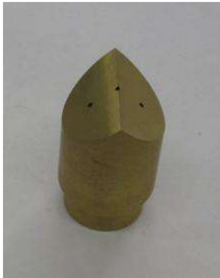
Figura 47 – Sonda tipo prisma fabricada em latão
