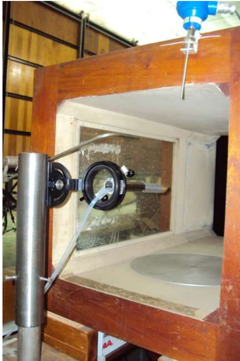
Figura 49 – Montagem do dispositivo posicionador no cilindro de regulagem vertical de altura no túnel de vento do laboratório de anemometria do IPT.
