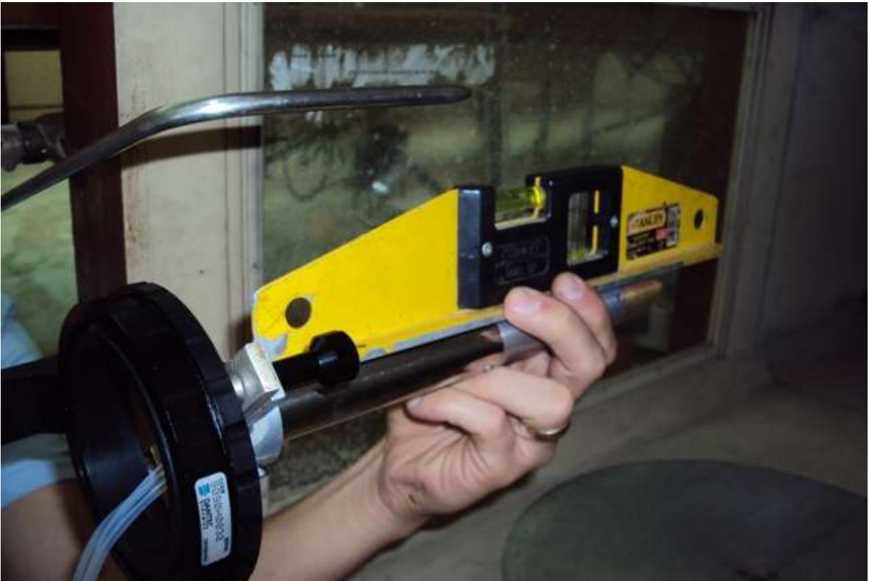
Figura 54 – Nivelamento da sonda antes dos ensaios.
