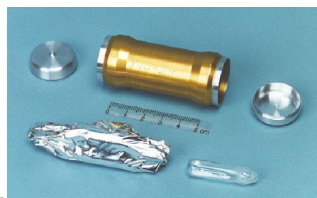
Figura 6 - Cápsula metálica utilizada no Preparative Neutron Activation (PNA) do Paul Scherrer Institute (PSI). (FRAJTAG, 2013)
