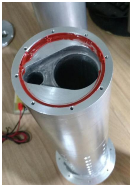
Figura 40 – Detalhe da vedação de silicone no fechamento do tubo e irradiação
