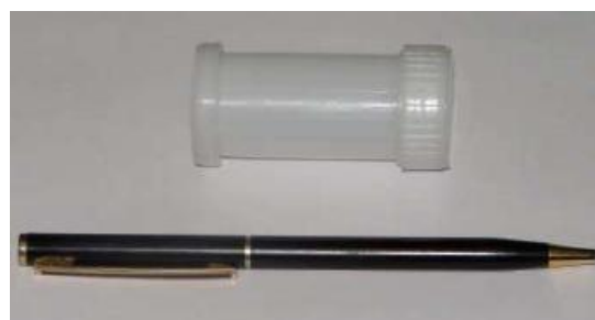
Figura 8 – Cápsula de PEAD utilizada no IEA-R1. (FERNANDO, 2011)
