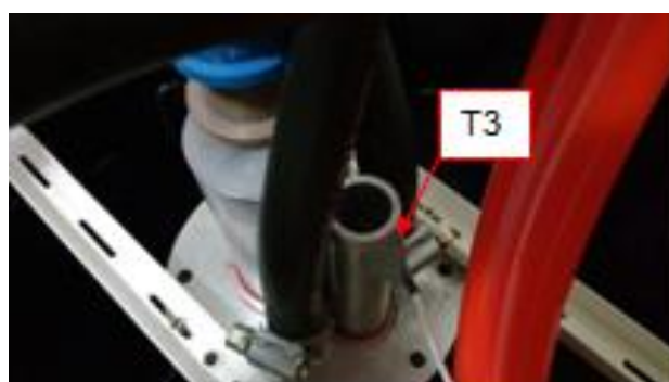
Figura 38 – Fotografia da fixação do termopar T3
