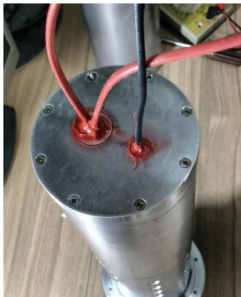
Figura 41 – Detalhe da passagem dos cabos para energização da resistência elétrica e cabos compensados dos termopares
