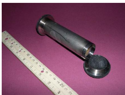
Figura 7 - Cápsula 2PH1 de titânio utilizada no MIT Nuclear Reactor Laboratory (MITR-NRL). (CARPENTER et. al., 2012)
