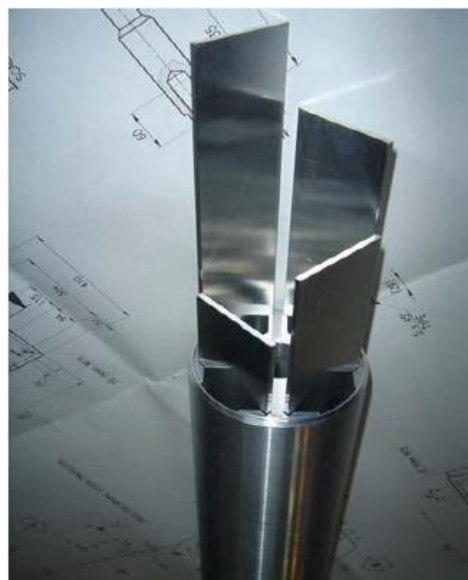
Figura 14 – Placas para irradiação de \text{Mo}^{99} no reator OPAL. (STORR, 2009)
