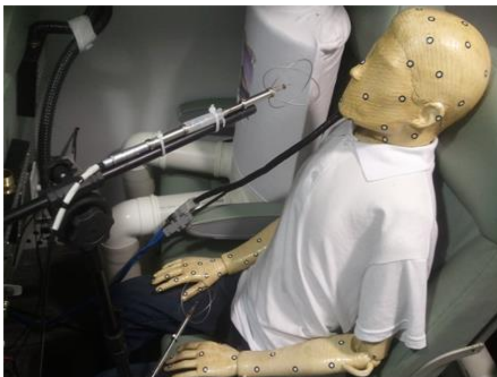
Figura 4.19 - Posicionamento das sondas para medição de temperatura e velocidade do ar na altura de 0,60 m e de 1,10 m a partir do piso (Fabichak Jr., 2013)
