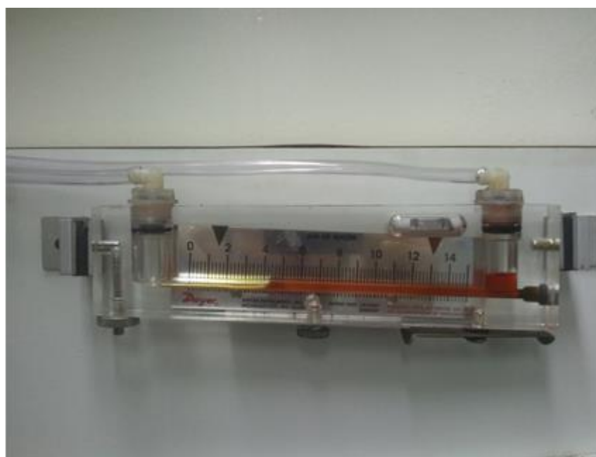
Figura 4.22 - Manômetro diferencial para a determinação e monitoramento da vazão de ar (Fabichak Jr., 2013)
