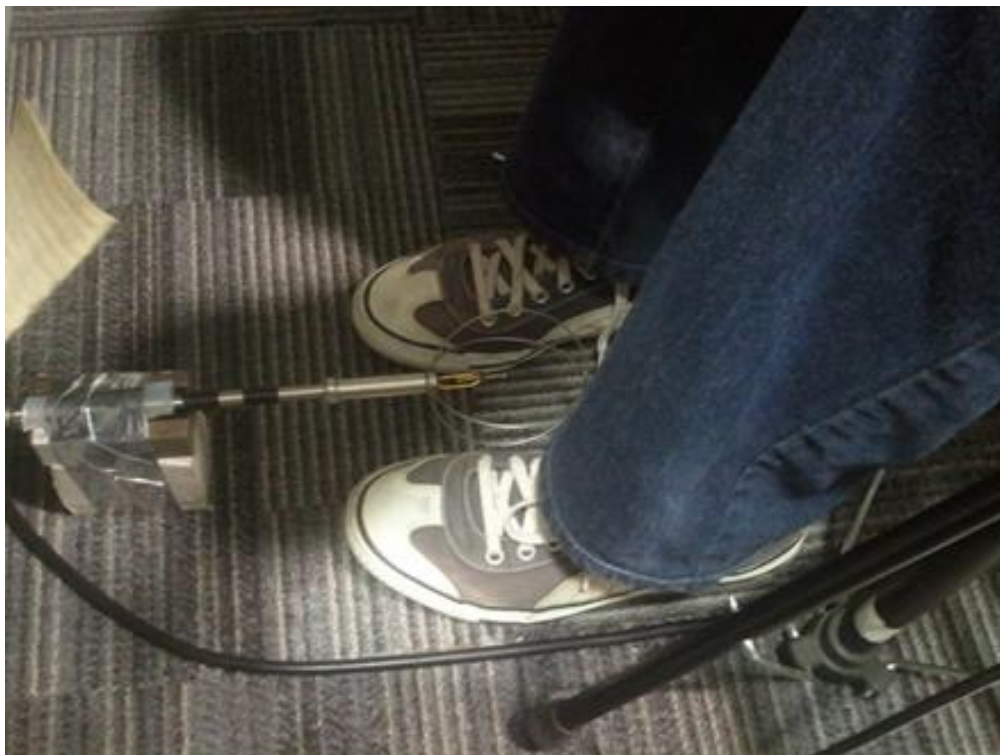
Figura 4.20 - Posicionamento das sondas para medição de temperatura e velocidade do ar na altura de 0,10 m a partir do piso (Fabichak Jr., 2013)
