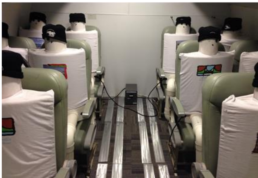
Figura 4.8 - Localização Vista interna do mock-up com os manequins aquecidos
