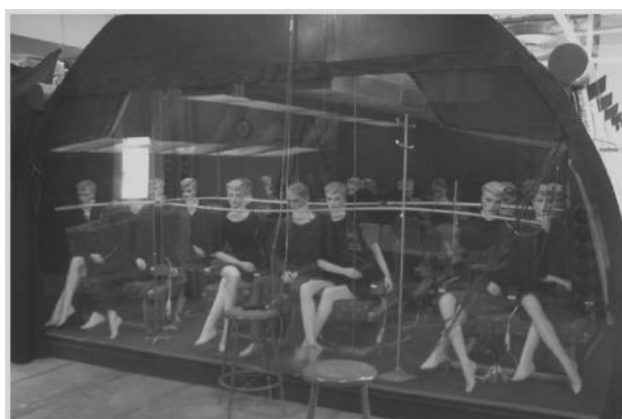
Figura 2.16 - Estudo da dispersão de contaminantes em mock-up de Boeing 767-300 (Yan et al., 2009)
