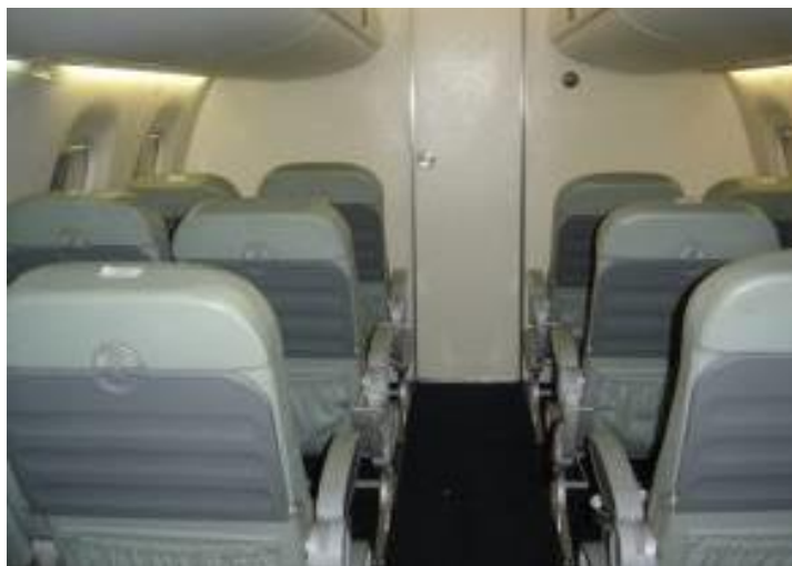
Figura 2.24 - Mock-up de 20 lugares utilizado na avaliação da dispersão de partículas (Conceição, 2012)
