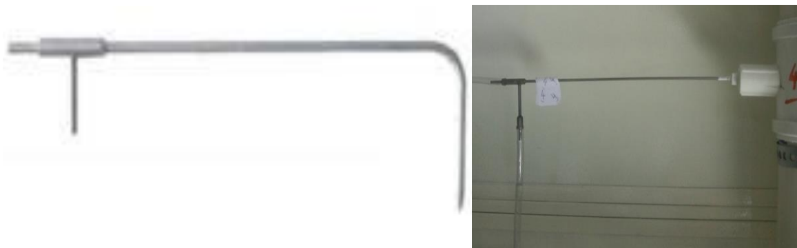
Figura 4.21 - Vista dos tubos de Pitot antes e após a instalação (Fabichak Jr., 2013)
