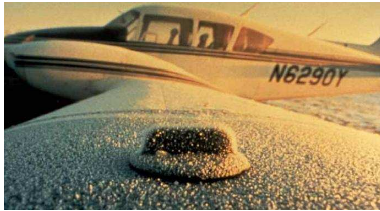
Figura 1.3: Gelo acumulado na asa de uma aeronave no solo (LANDSBERG, 2008)
