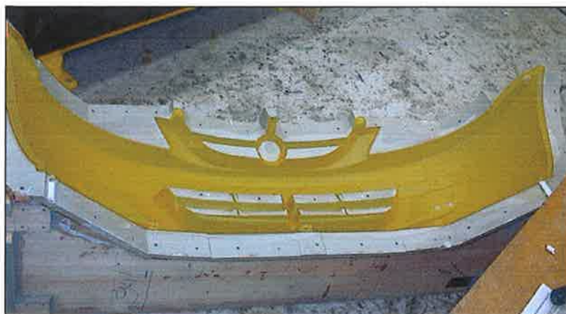
Figura 4.12 – Metade do molde de um pára-choque dianteiro com a peça. (Braga, 2001).
