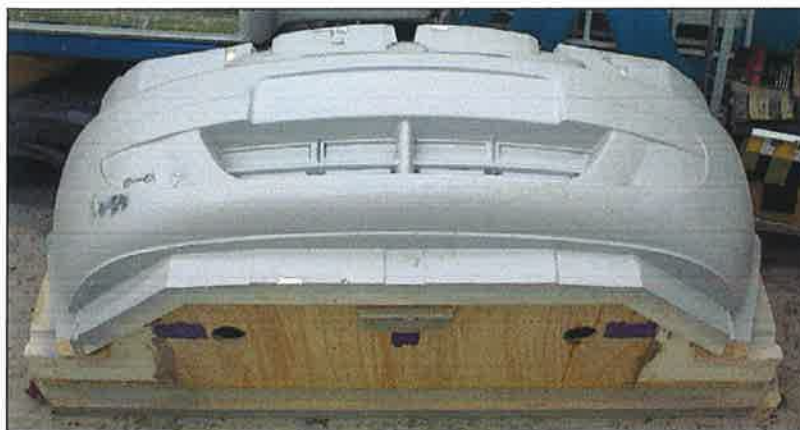
Figura 4.13 – Segunda metade do molde de um pára-choque dianteiro. (Braga, 2001).
