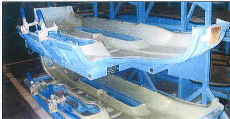
Figura 4.9 – Gabarito ou berço para cura de um pára-choque em resina. (Revista do Plástico Reforçado – Composites, 2003).
