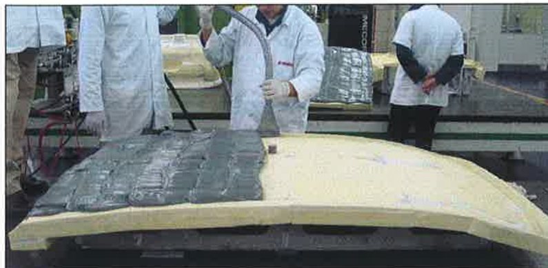
Figura 2.6 – Deposição de resina formulada sobre uma base. (Braga, 2001).
