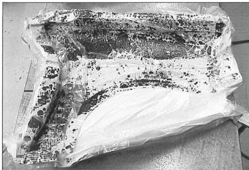
Figura 4.8 – Molde de um pára-lama dianteiro dentro do invólucro sob pressão negativa. (Macarrão, 2004).
