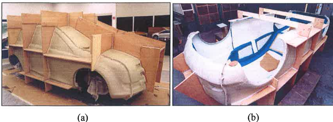
Figura 4.10 – (a) Molde sobre o modelo em clay de uma carroceria; (b) Mesmo molde após desmoldagem. (Macarrão, 2004).
