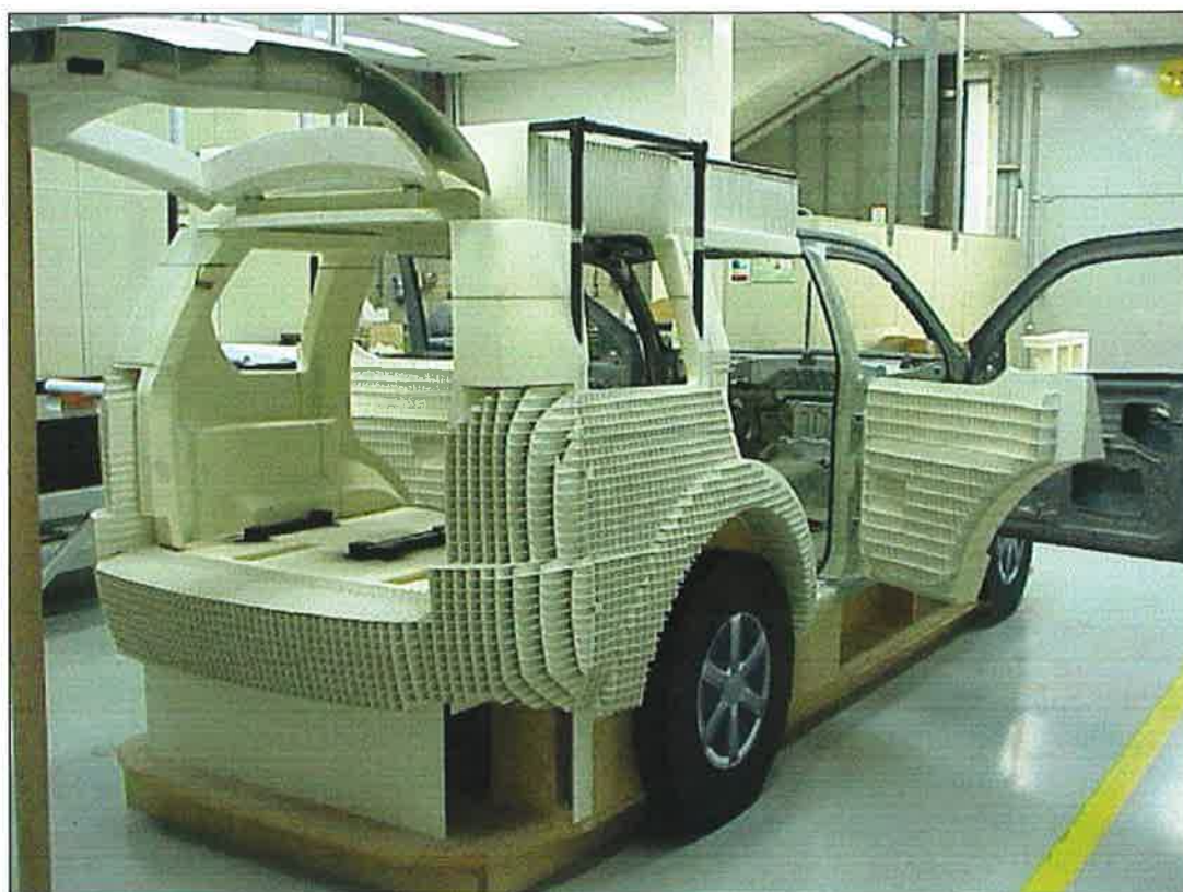
Figura 3.16 – Mock-up de perua constituído de peças metálicas e várias técnicas de fabricação. (Macarrão, 2004).
