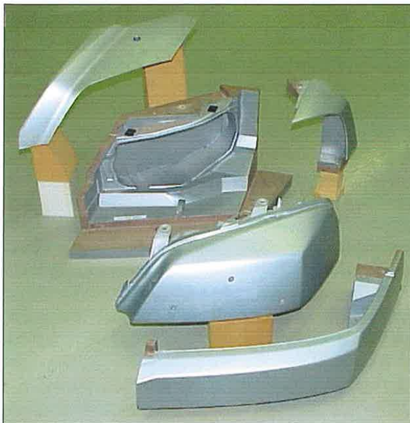
Figura 3.13 – Cubing desmontado do farol esquerdo. (Macarrão, 2004).
