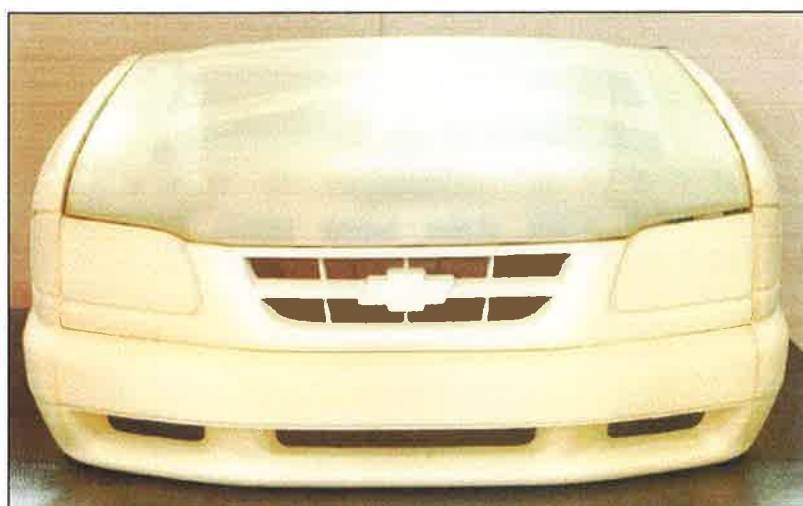
Figura 4.11 – Frente protótipo em fibra de vidro de uma picape para teste dinâmico de arrefecimento do motor. (Macarrão, 2004).
