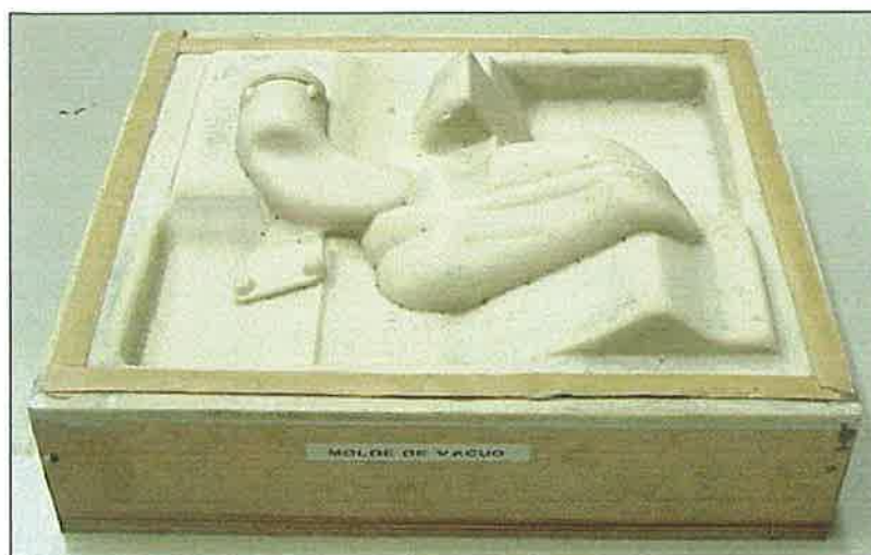
Figura 4.18 – Molde da metade de um reservatório de fluido. (Macarrão, 2004).
