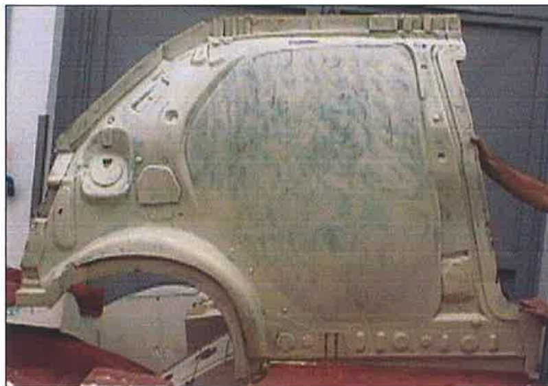
Figura 2.16 – Molde para laminação da parte traseira do painel lateral interno de uma carroceria. (Macarrão, 2004).
