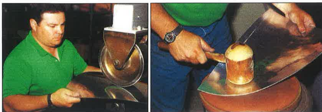
Figura 4.21 – Operações manuais de conformação de chapa metálica. (Fournier e Fournier, 1989).
