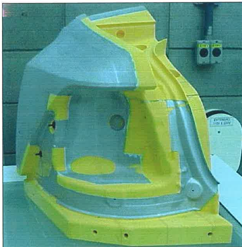
Figura 3.14 – Modelo modificado de um cubing da lanterna traseira. (Macarrão, 2004).
