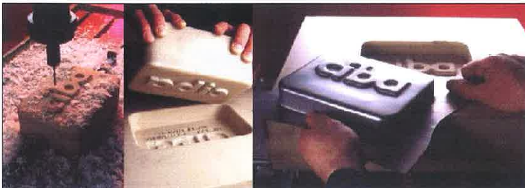
Figura 4.23 – (a) Usinagem do punção em resina; (b) Ferramenta de conformação usinada em resina; (c) Peça metálica conformada. (Barros, 2001).
