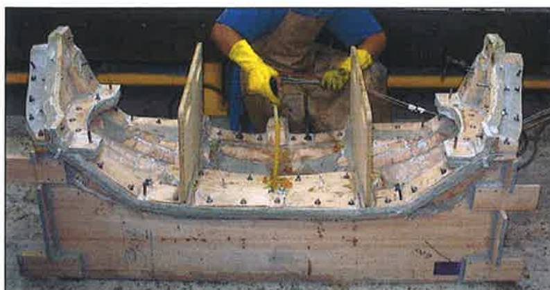
Figura 4.15 – Molde fechado de um pára-choque dianteiro durante a injeção de resina. (Braga, 2001).
