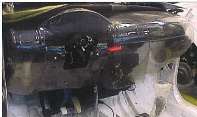
Figura 4.17 – Painel de instrumentos em PETG. (Macarrão, 2004).
