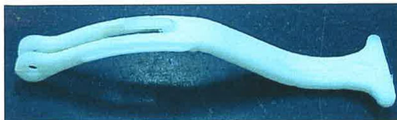
Figura 4.1 – Trava do capô em poliuretano. (Adaptado de Macarrão e Kaminski, 2003).
