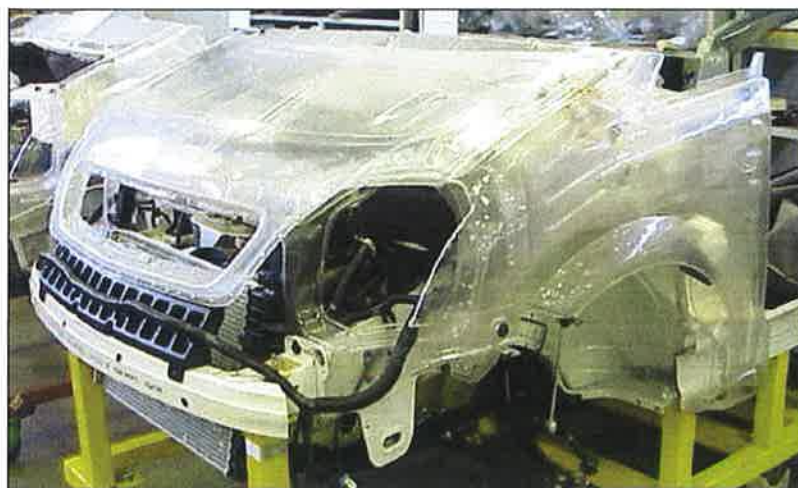
Figura 4.20 – Carroceria parcial fabricada em PETG pelo processo vacuum forming . (Macarrão, 2004).
