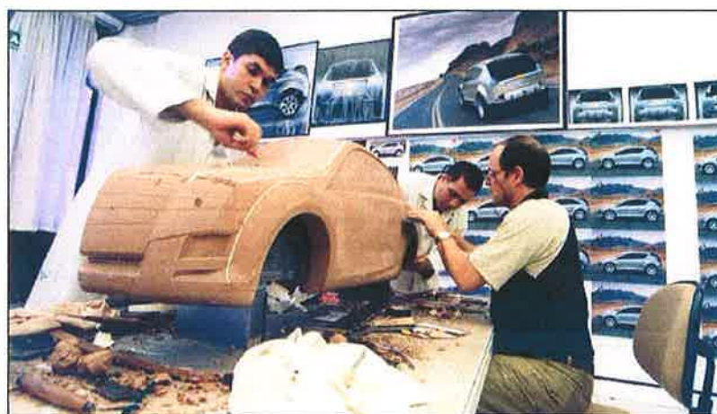
Figura 2.4 – Modelo parcial em escala reduzida do lado esquerdo de um veículo para utilização com espelho plano. (Macarrão, 2004).
