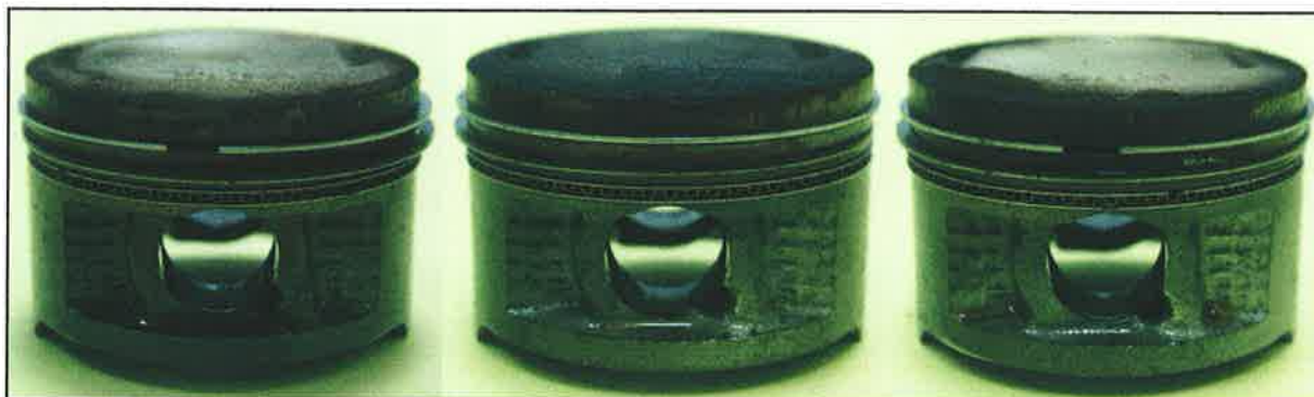
Figura 16: Vista lateral do pistão do motor E25 (esquerda), motor C-9 (centro) e motor E40 (direita).
