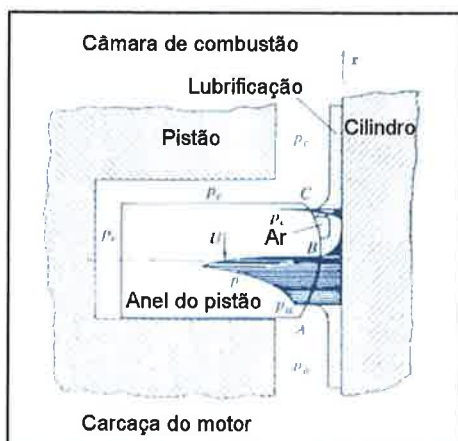
Figura 3: Distribuição de pressão no filme de óleo lubrificante no tempo de expansão, corte longitudinal (HEYWOOD, 1988).
