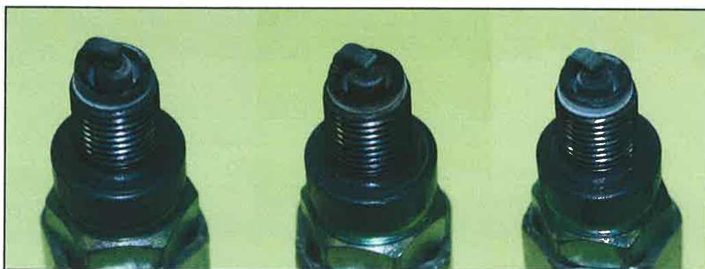
Figura 20: Vela de ignição do motor E25 (esquerda), motor C-9 (centro) e motor E40 (direita).
