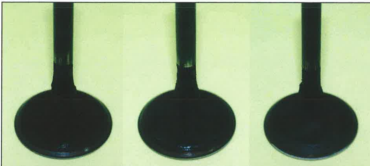
Figura 12: Válvulas de admissão do motor E25 (esquerda), motor C-9 (centro) e motor E40 (direita).
