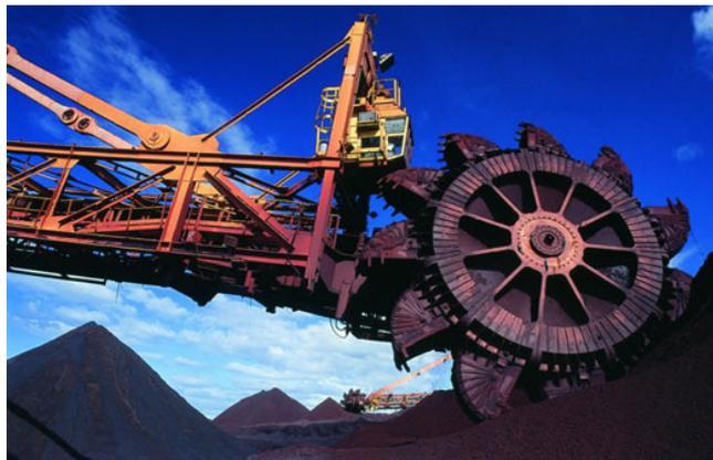
Figura 7– Retomador de lança com roda de caçambas (Flender, 2009)
